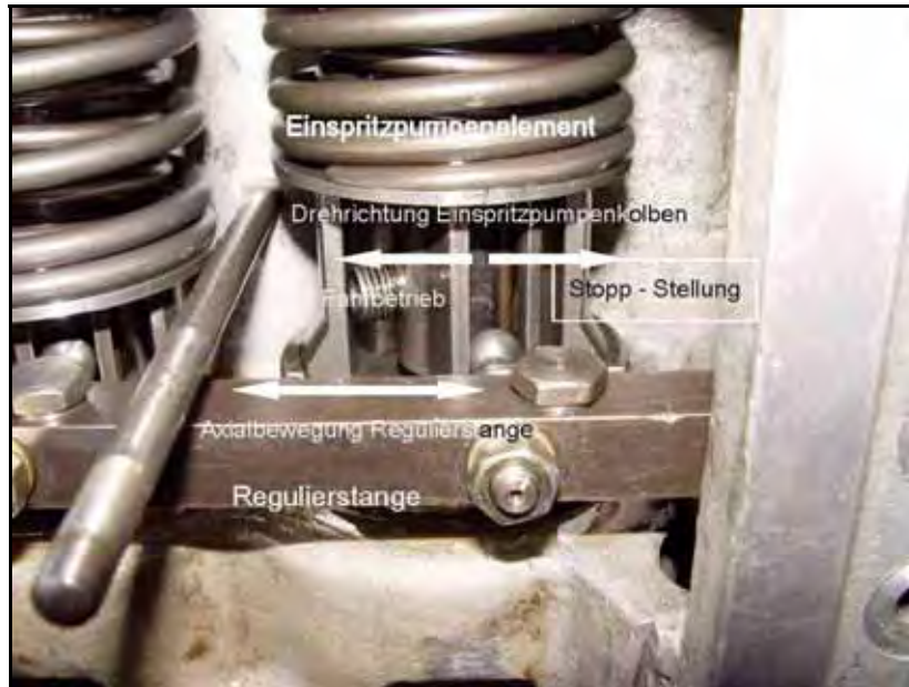
Abbildung 27: Regulierstange an neuwertiger Einspritzpumpe
