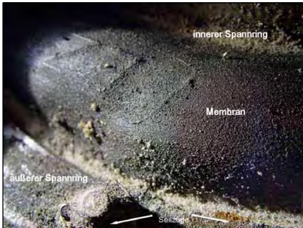
Abbildung 31: Oberfläche der getriebeseitigen Membran
