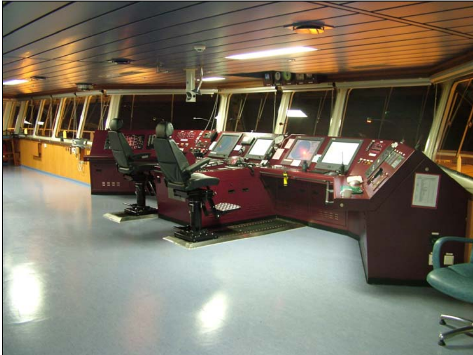
Abbildung 10: Anordnung der Brückenkonsolen auf LT CORTESIA
