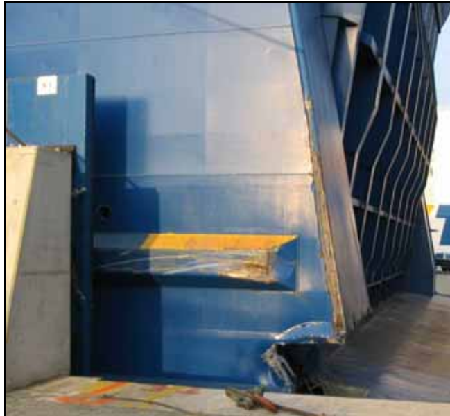
Abbildung 3: Schaden an der Backbord Außenhaut der FINNLADY
