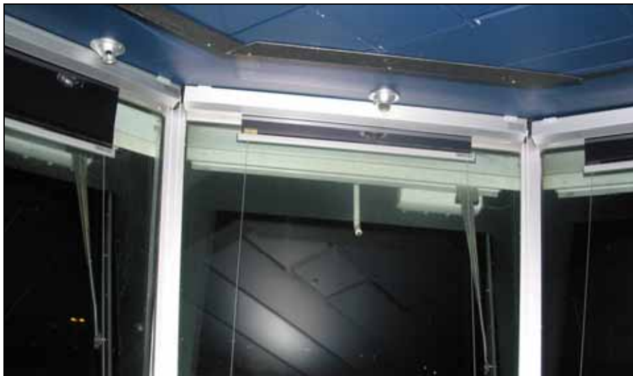
Abbildung 16: Brückenfenster mit Rollos
