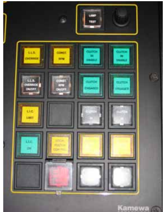
Bild 6: Nocken-Fahrstand - Lastkontrolle, Betriebsmodus (Umschalter und Anzeige)
