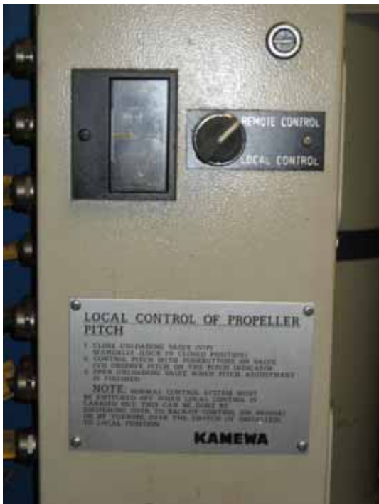
Bild 15: Umschaltung Fahrautomatik - Notbetrieb
