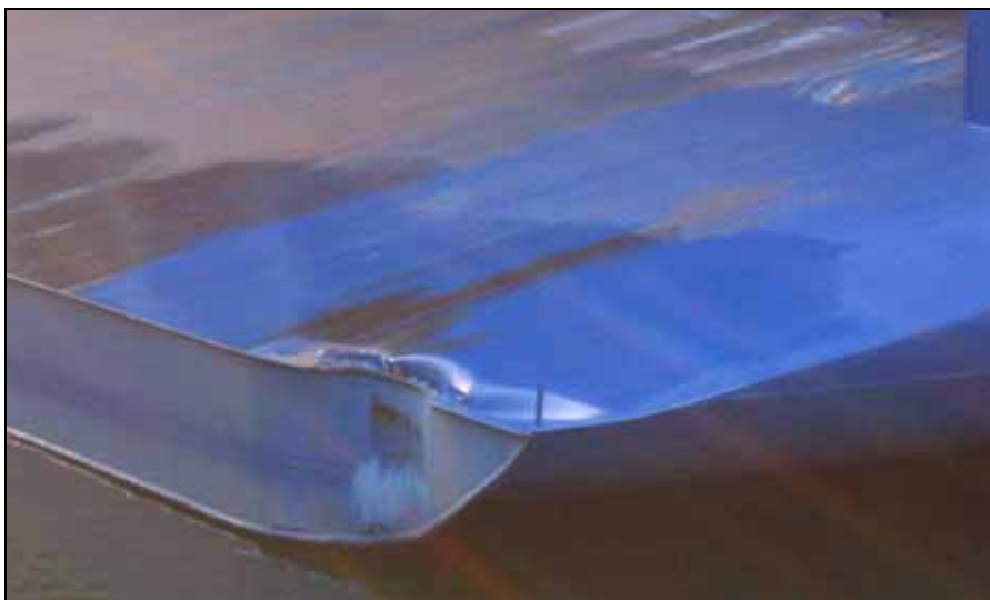
Abbildung 6: Schaden an der Steuerbordseite des Heckspiegels der FINNLADY
