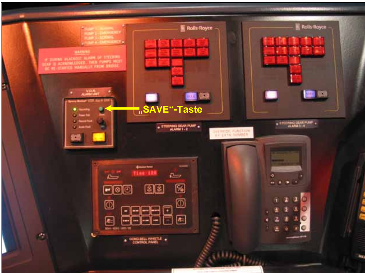
Abbildung 25: VDR-Bedienfeld am zentralen Fahrstand
