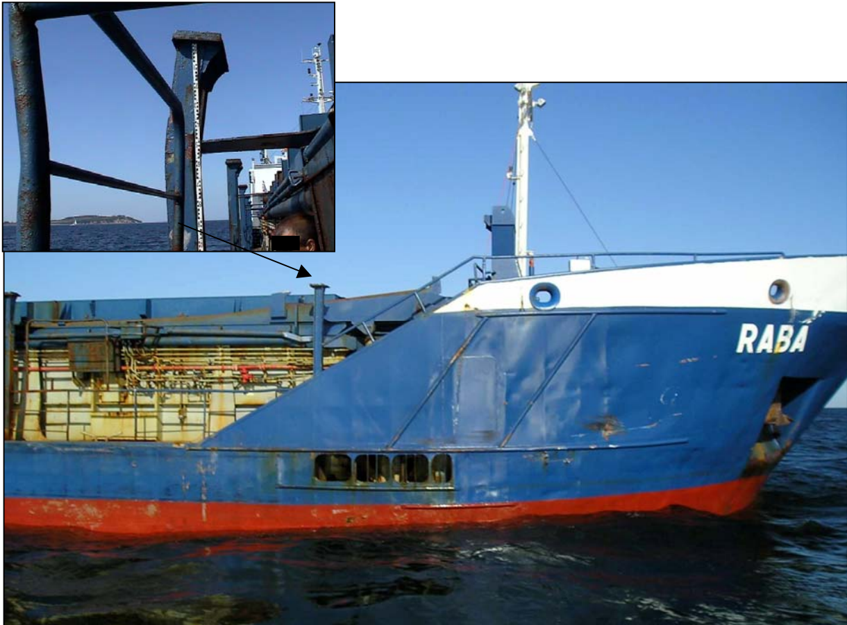
Abbildung 5: Schäden am Vorschiff der RABA
