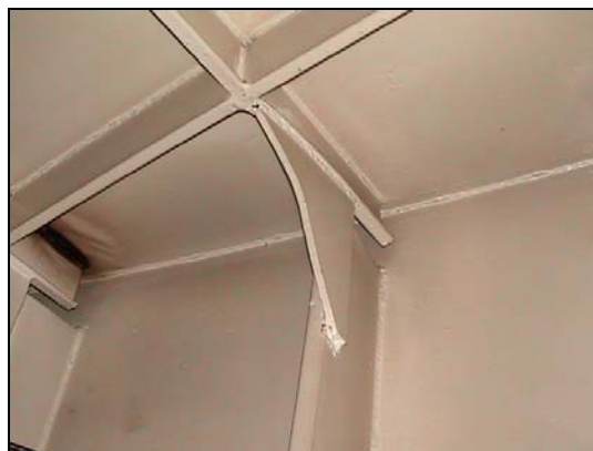
Abbildung 6: Spantenverformung auf der RABA
