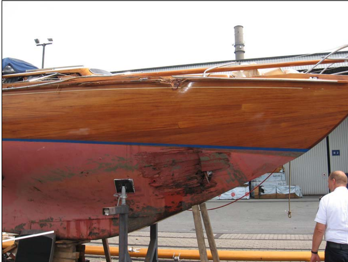
Abbildung 4: Eingedrückte Planken der RØDE ORM im Unterwasserbereich
