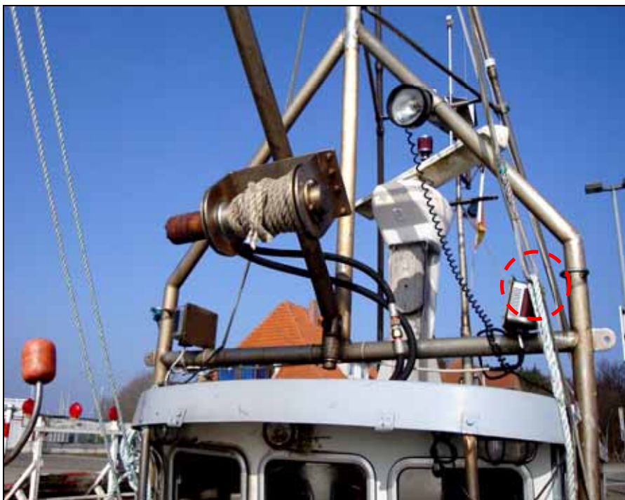
Abbildung 7: Ladegeschirr (Detailaufnahme Querverstrebung des Mastes)
