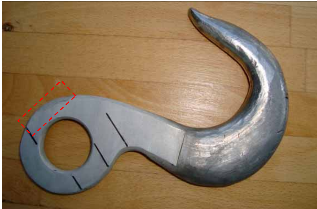
Abbildung 21: Haken mit Fertigungsschweißung (rot markiert) und Walzrichtung 7
