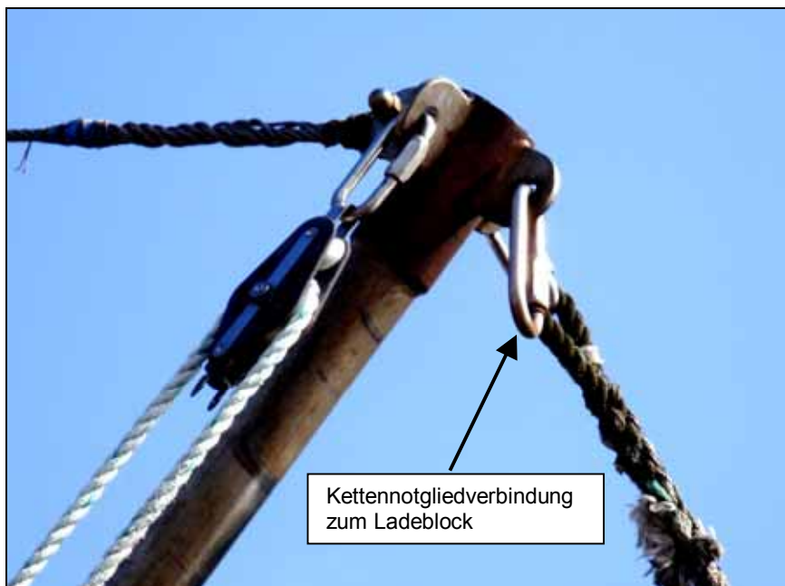
Abbildung 9: Baumnock mit angeschlagenen Kettennotgliedern
