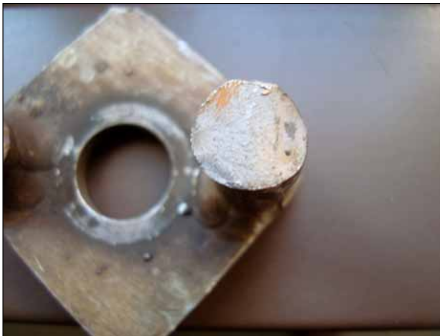
Abbildung 15: Detailaufnahme der sekundären Bruchfläche
