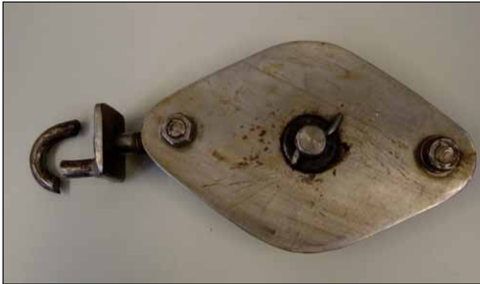
Abbildung 10: Ladeblock mit gebrochener Öse
