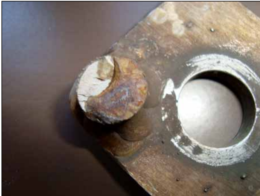
Abbildung 14: Detailaufnahme der primären Bruchfläche
