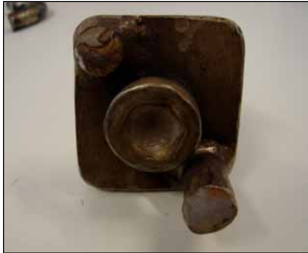
Abbildung 12: Ösenhalterung (Draufsicht Bruchseite)
