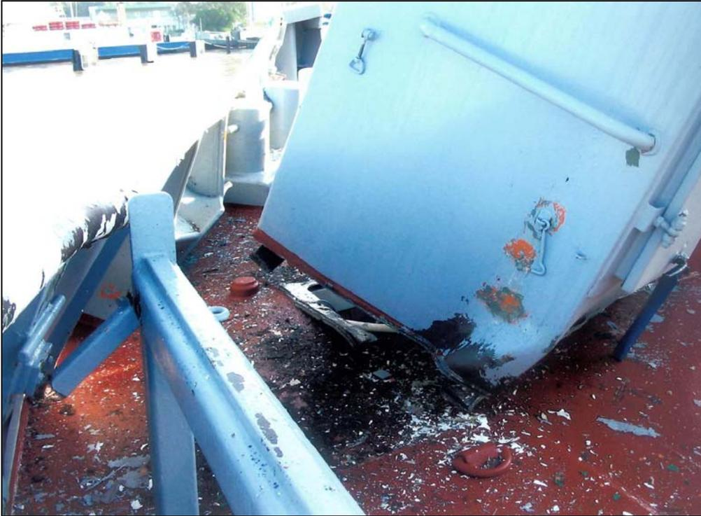
Abbildung 9: CROWN BREEZE – Schäden auf der Back
