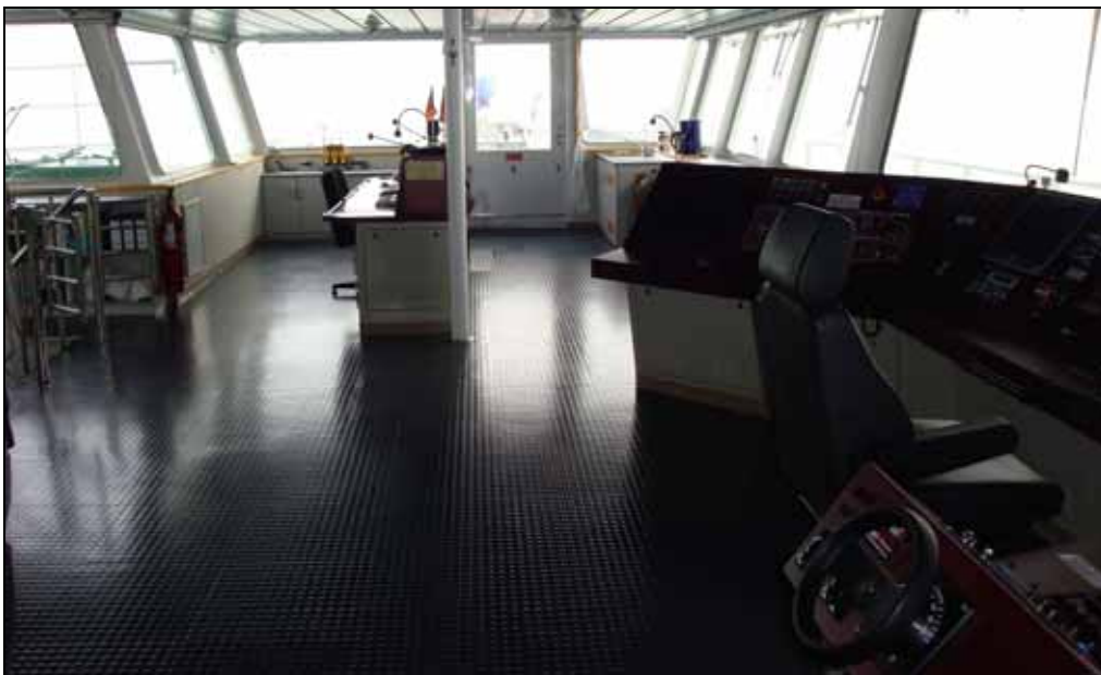
Abbildung 21: fehlende Handläufe Backbordseite Brücke
