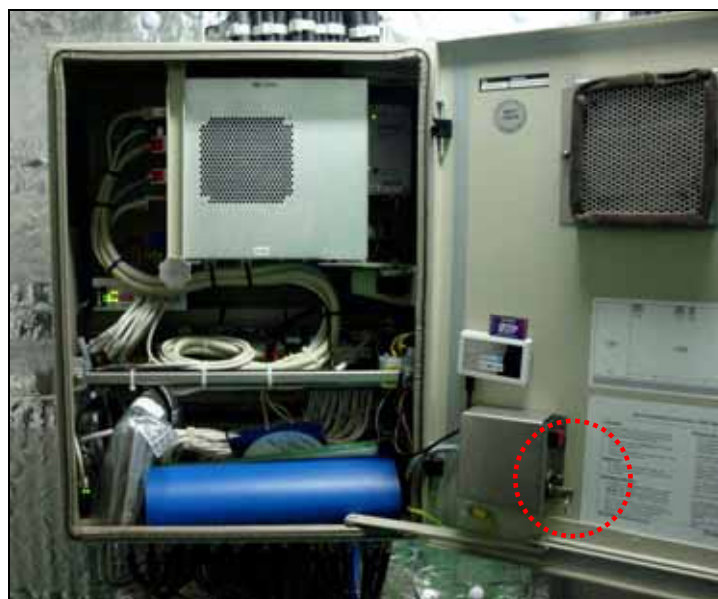
Abbildung 41: Schalter für Notfallspeicherung in der Main Unit
