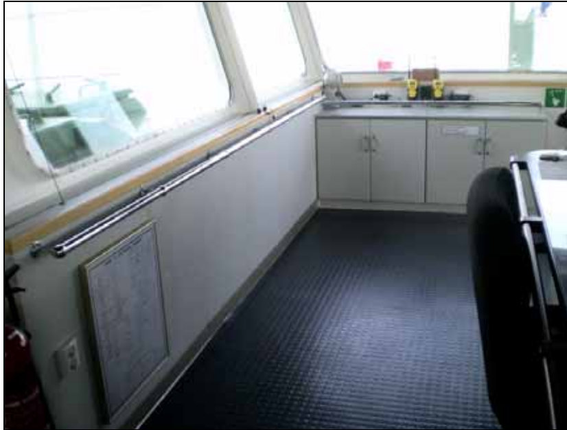
Abbildung 45: Handlauf Backbordseite und Achterkante Brücke
