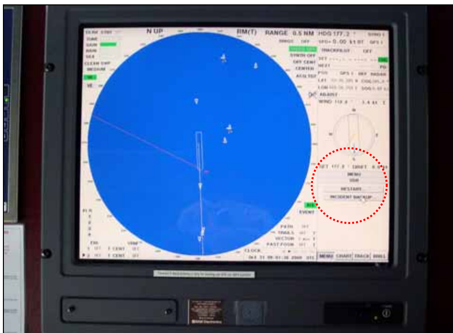
Abbildung 39: Schaltfläche für Notfallspeicherung im Backbord-Radargerät
