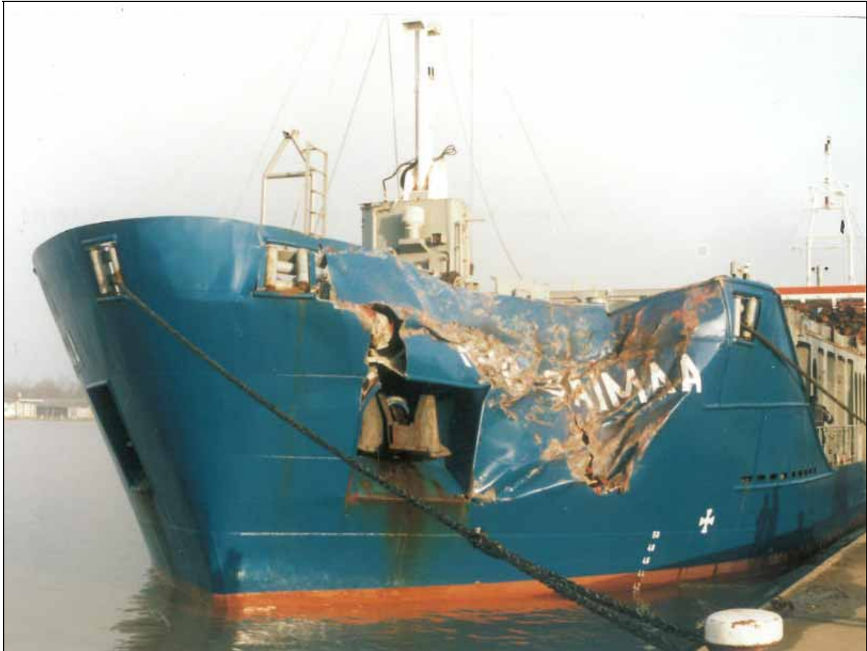
Abbildung 6: Schäden an RMS SAIMAA
