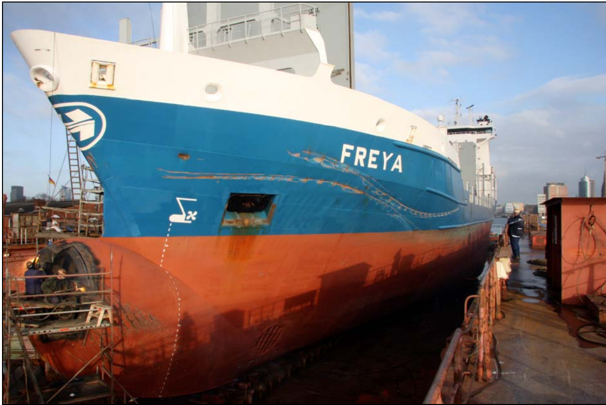
Abbildung 5: Beschädigte Backbordseite der FREYA
