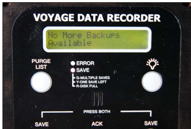
Abbildung 13: Hinweisanzeige im S-VDR-Display
