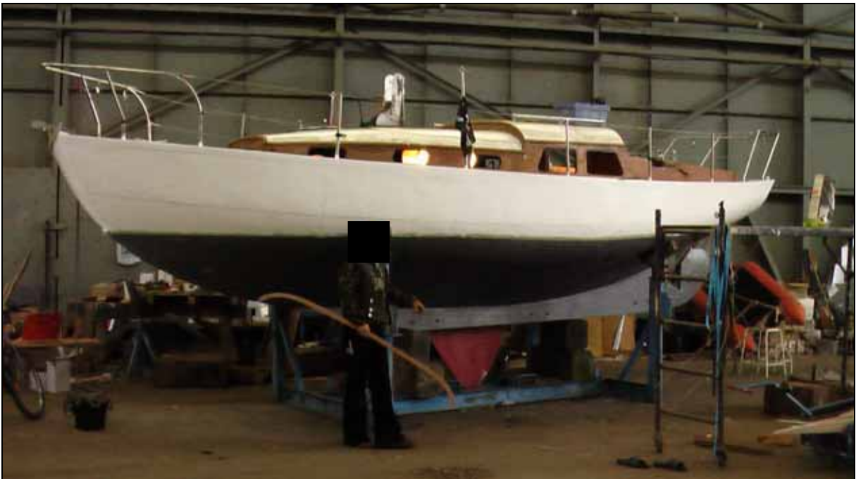
Abbildung 13: TAUBE während der Restauration, montiertes Schwert
