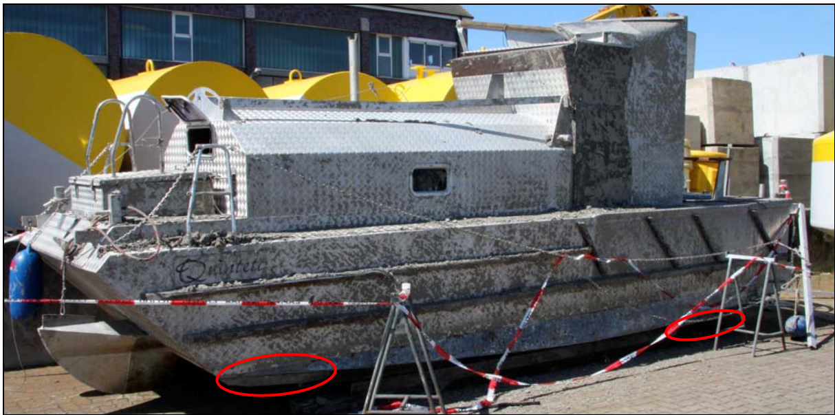
Abbildung 11: Anordnung der Schlingerkiel auf der Backbordseite
