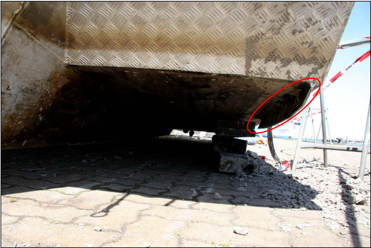
Abbildung 9: Unterschiff Backbordseite mit Ballast- und vorderem Schlingerkiel
