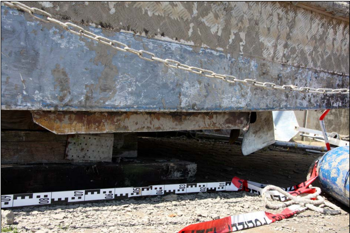
Abbildung 10: Schlingerkiel Backbord achtern, Seitenansicht
