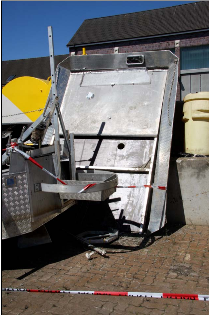
Abbildung 13: Abgerissenes Dach der QUINTETT
