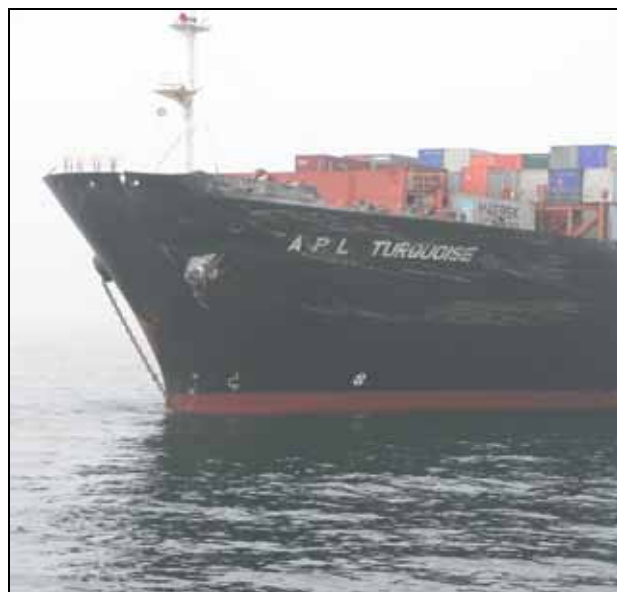
Abbildung 5: Schäden APL TURQUOISE
