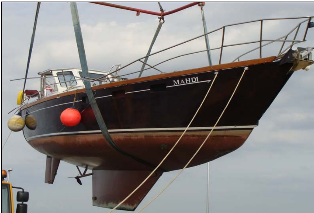
Abbildung 8: Beschädigung Steuerbordreling SY MAHDI 10
