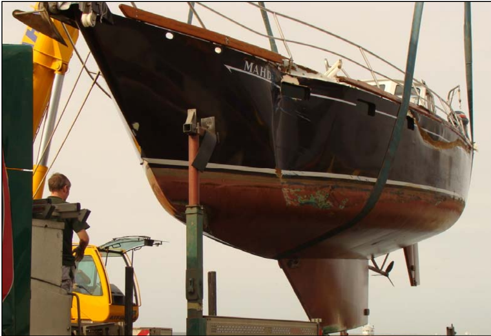
Abbildung 7: Beschädigungen SY MAHDI (Backbordseite)
