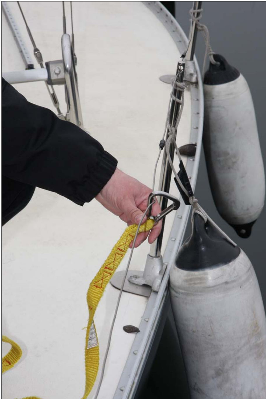
Abbildung 5: Entstehung des Knicks im Draht der Reling
