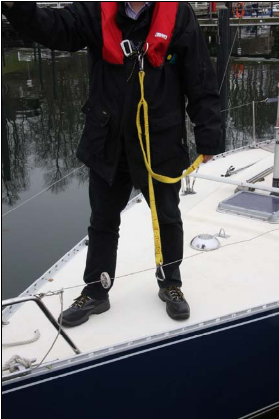
Abbildung 11: Richtige Länge der Sicherungsleine, dabei aber ungünstiger Sicherungspunkt
