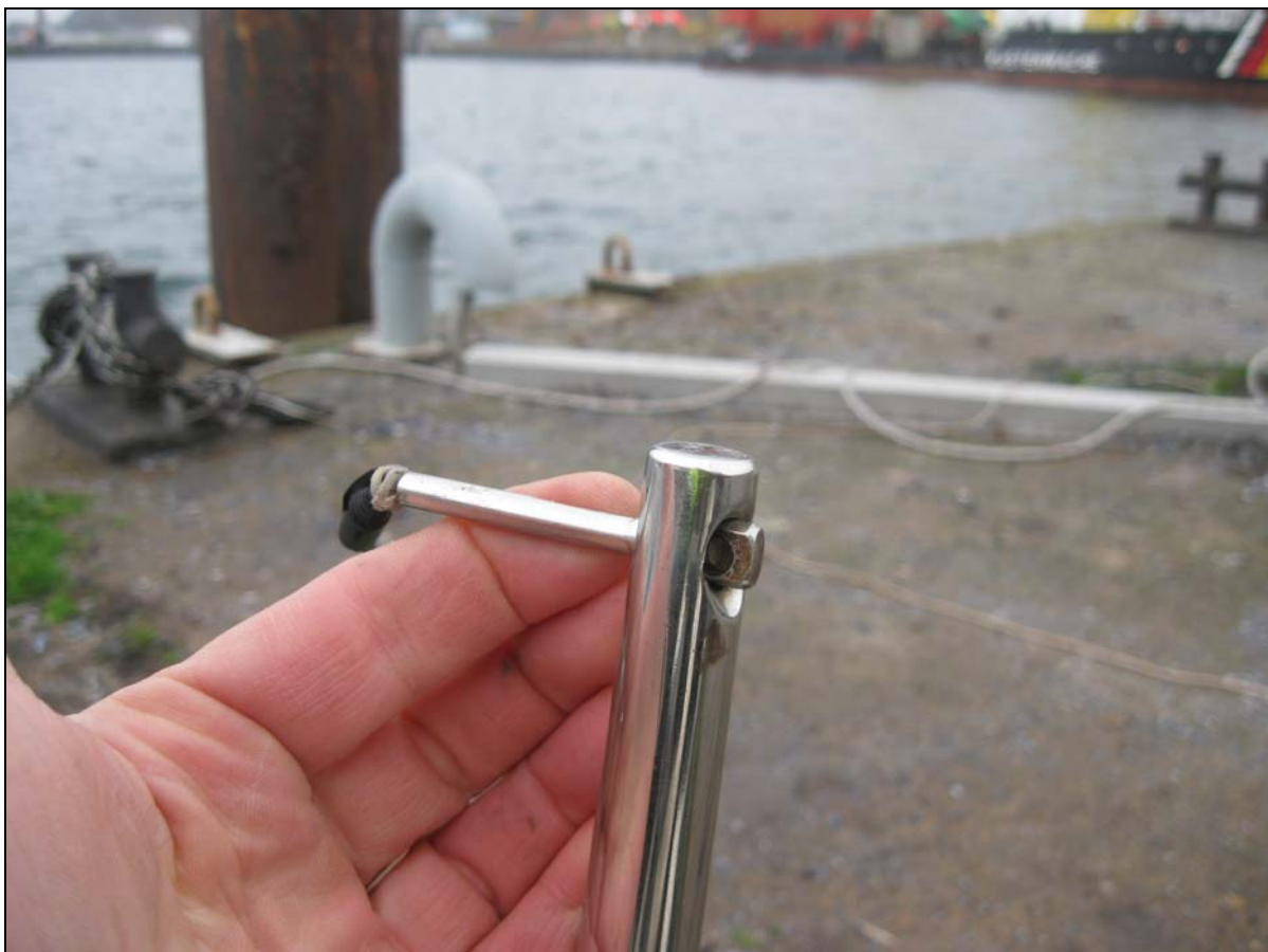
Abbildung 10: Terminal des Relingsdrahtes, durch die Führung der Relingsstützen passend
