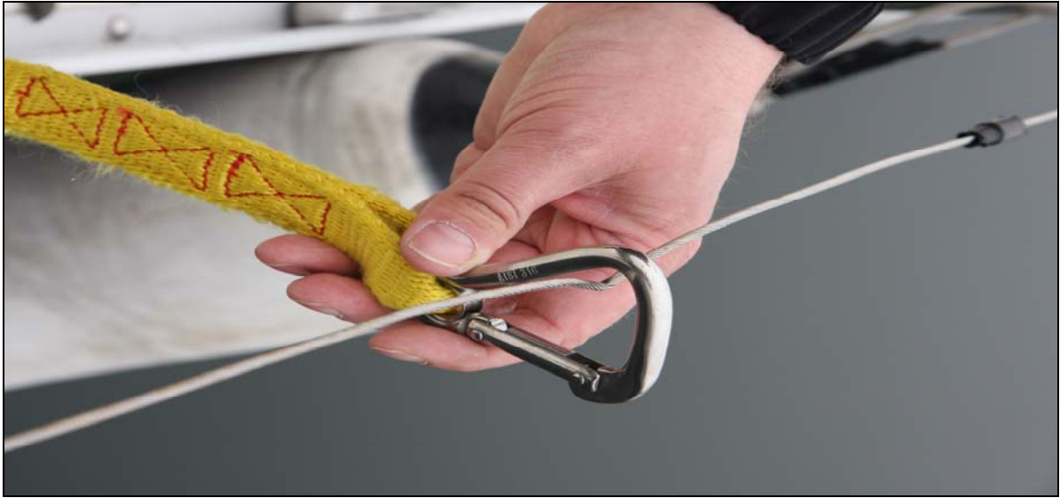
Abbildung 6: Am Relingsdraht eingepickte Sicherungsleine
