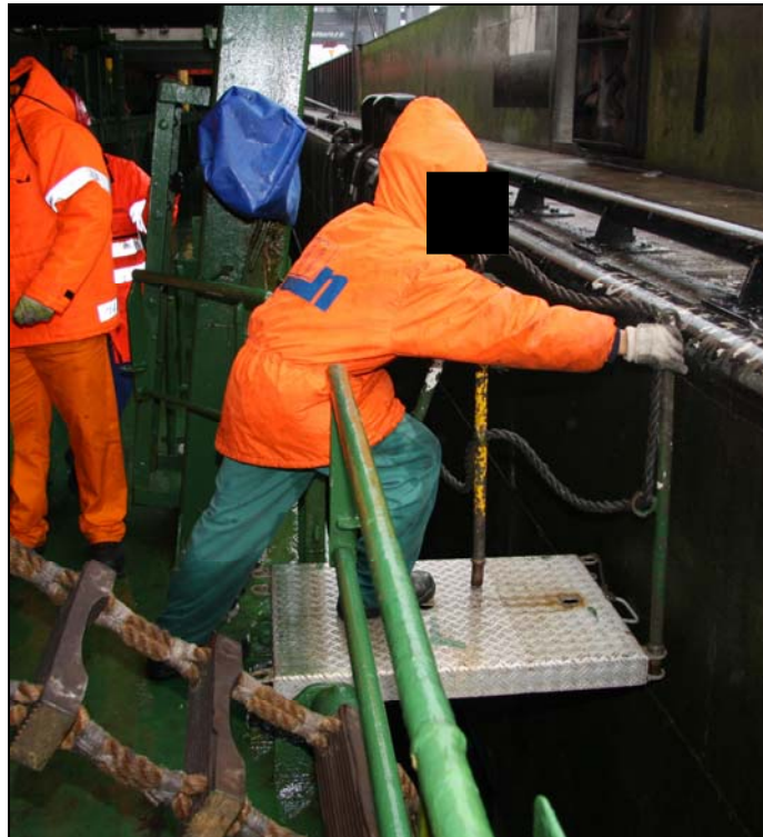
Abbildung 9: Setzen der Handreling, nachgestellt auf der Backbord-Lotsenstation
