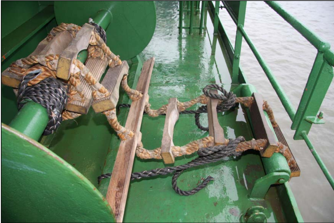
Abbildung 3: Ausgebrachte und gesicherte Lotsenleiter an Steuerbord, vorgefundener Zustand am Unfalltag
