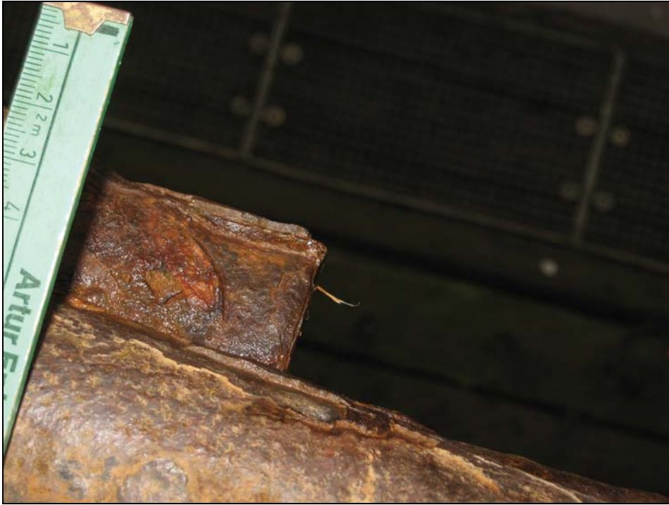
Abbildung 7: Faserrest an Beschädigung
