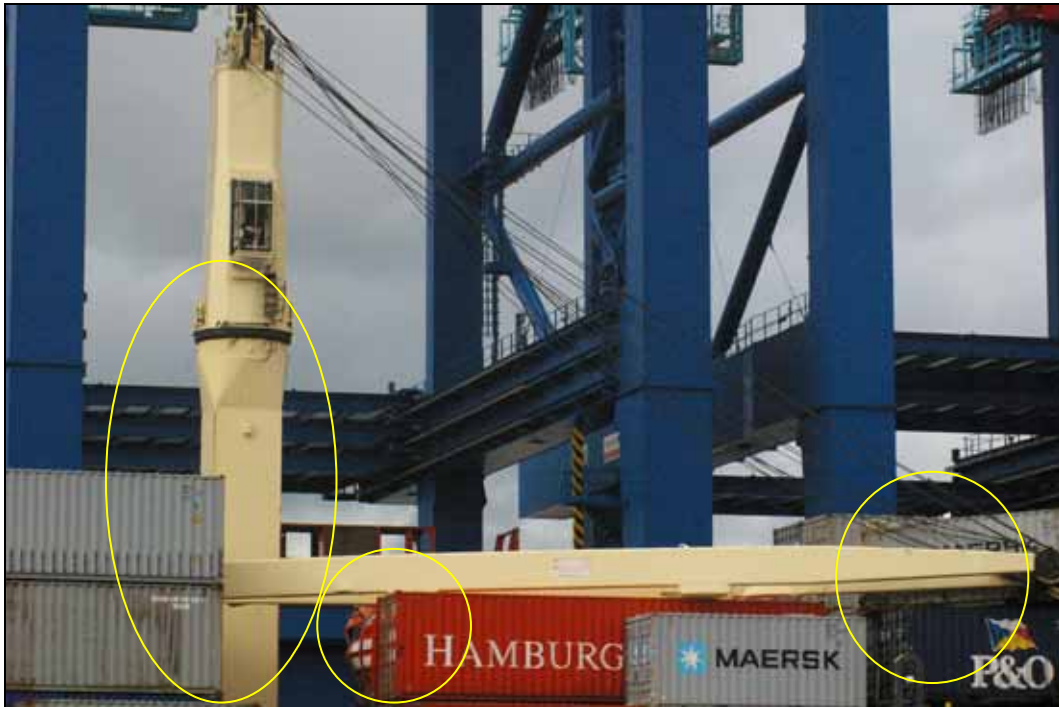
Abbildung 7: MAERSK NEWARK, abgerissener Kranausleger bei Kran 1 und beschädigte Container Die MAERSK BINTAN erhielt Beschädigungen am Rumpf und den Aufbauten (Abbildung 8). Die ausgebrachte Gangway wurde abgerissen.
