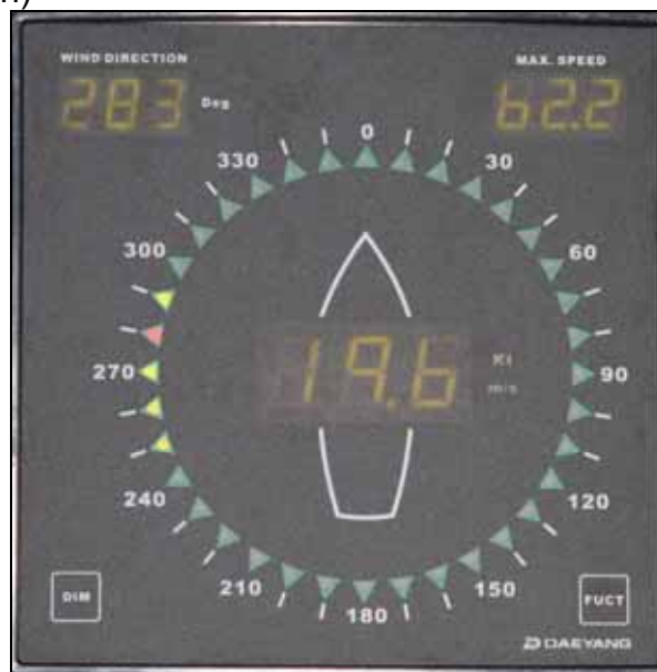
Abbildung 39: Anzeige der Windstärke und -richtung auf der Brücke der HÖEGH LONDON zum Zeitpunkt der Besichtigung durch die BSU, Anzeige der Windstärke in Knoten (leicht hinterleuchtet)
