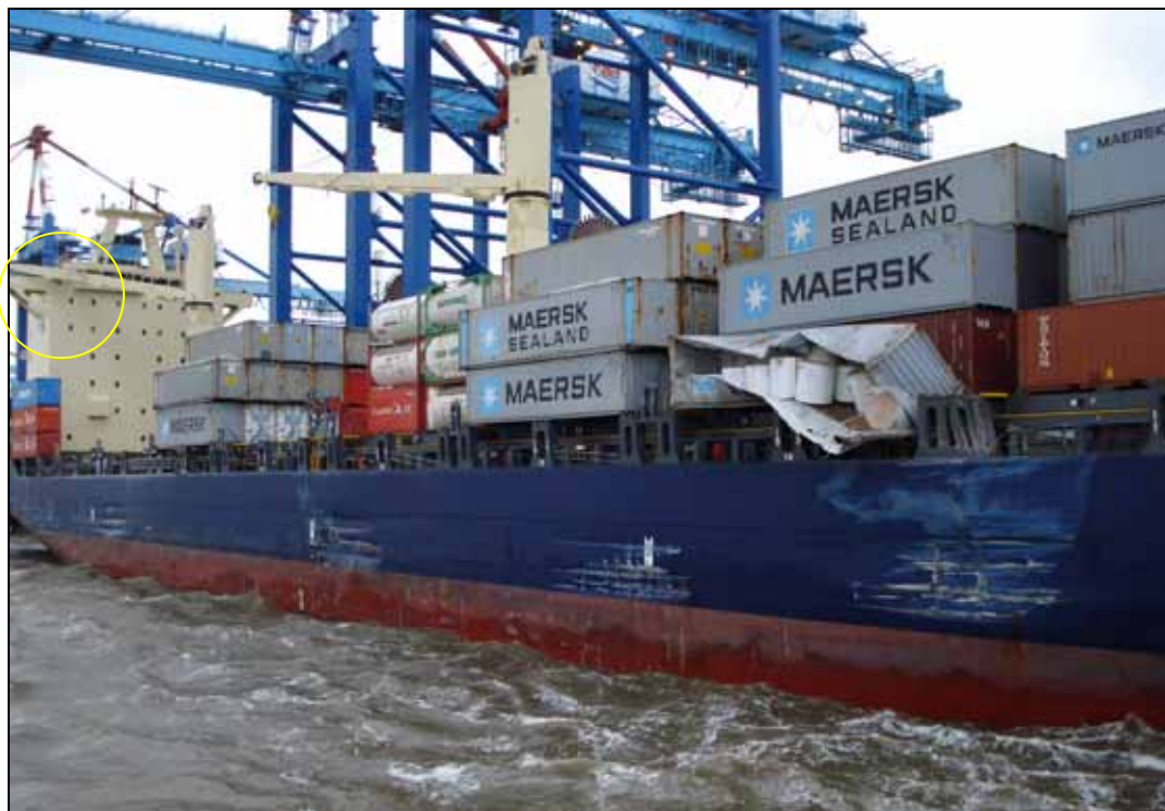
Abbildung 6: MAERSK NEWARK, beschädigter Rumpf, verdrehte und beschädigte Kräne
