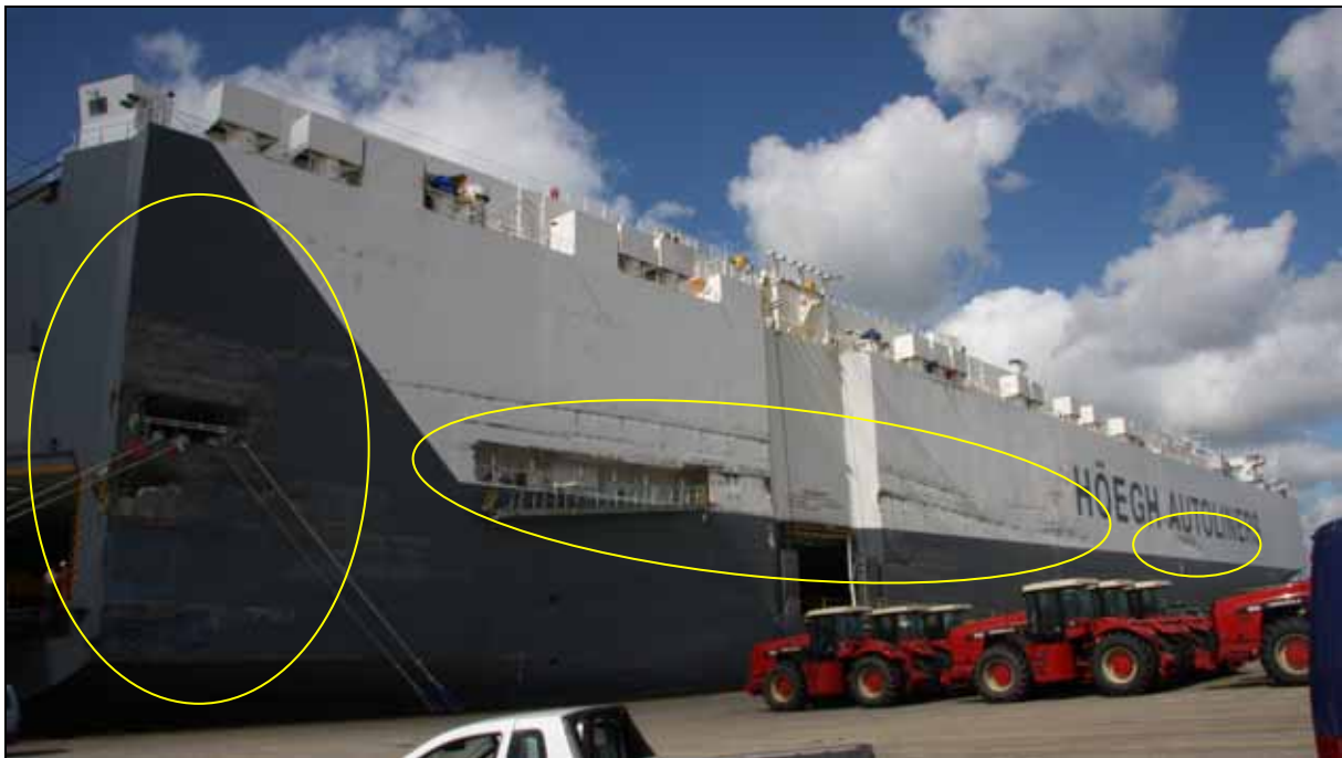
Abbildung 5: Seitenansicht HÖEGH LONDON mit Einbeulungen
