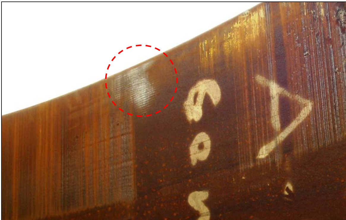
Abbildung 19: Abdruck Klemmbacke (Innenseite Pile)
