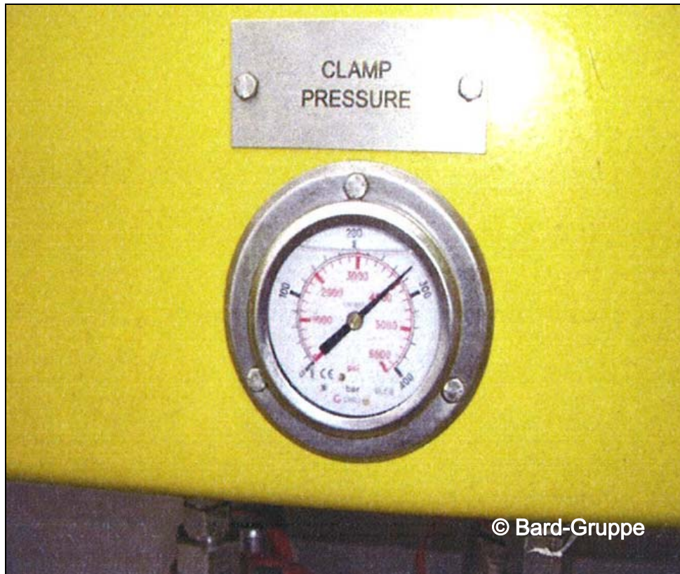
Abbildung 22: Analoge Druckanzeige Powerpack 38
