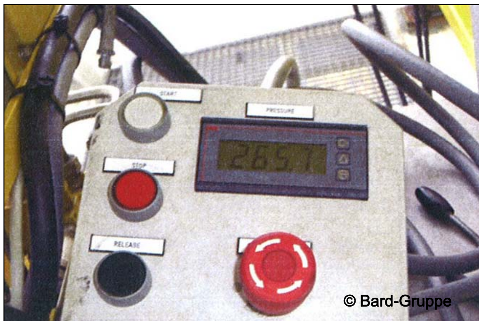
Abbildung 21: Kabelfernbedienung Fox - Digitale Druckanzeige
