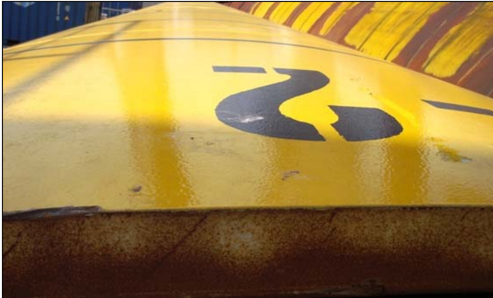
Abbildung 20: Außenseite Pile (keinerlei Andruckspuren)
