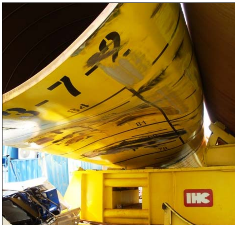
Abbildung 9: Deformiertes Pile (Ansicht von unten)
