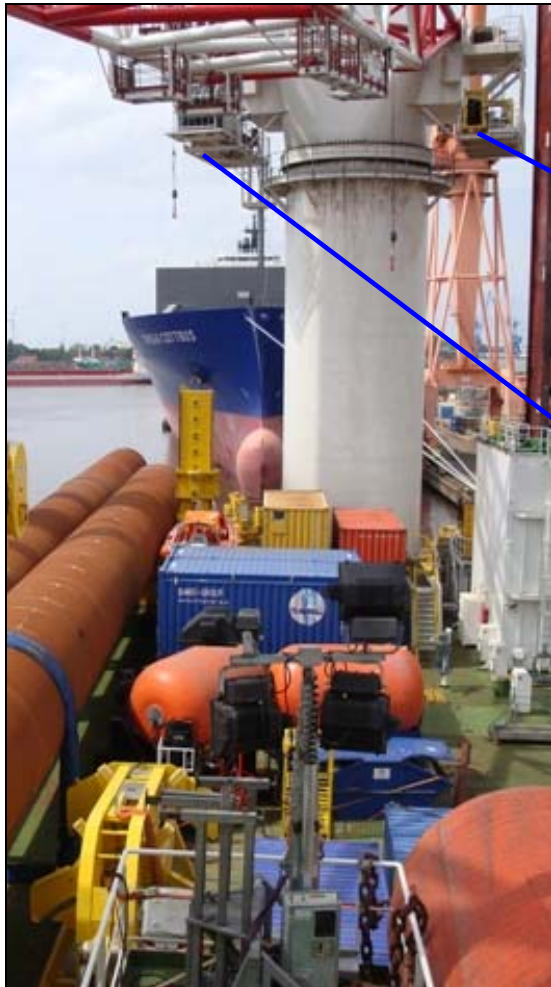
Abbildung 17: Kransäule mit Kranführerhaus und Fox-Bedienpodest
