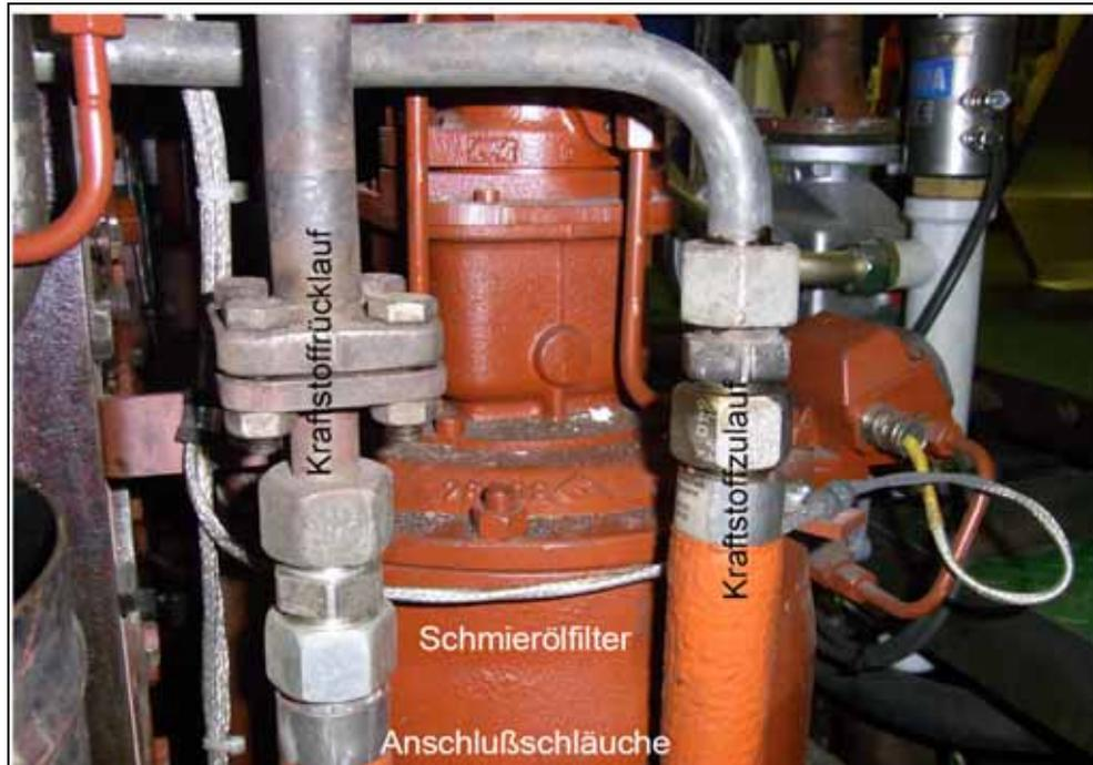
Abbildung 34: Schlauchanschlüsse an Kraftstoffleitung
