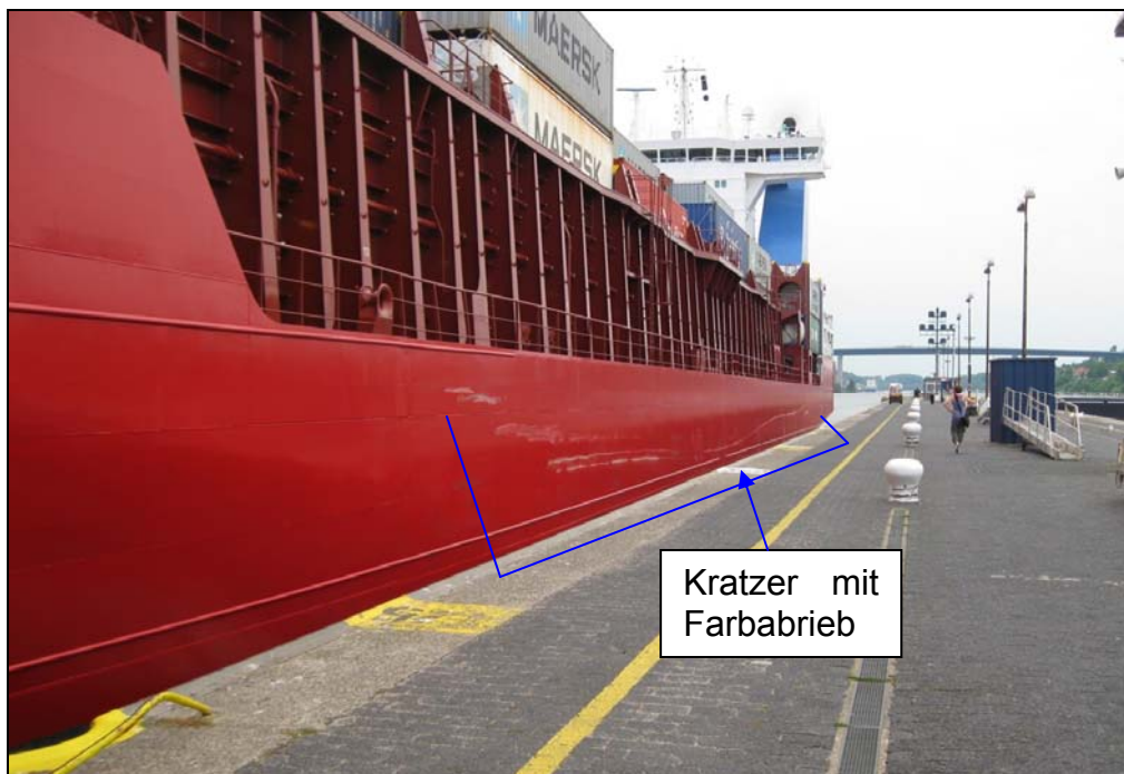
Abbildung 7: Schäden CMS NAVI BALTIC
