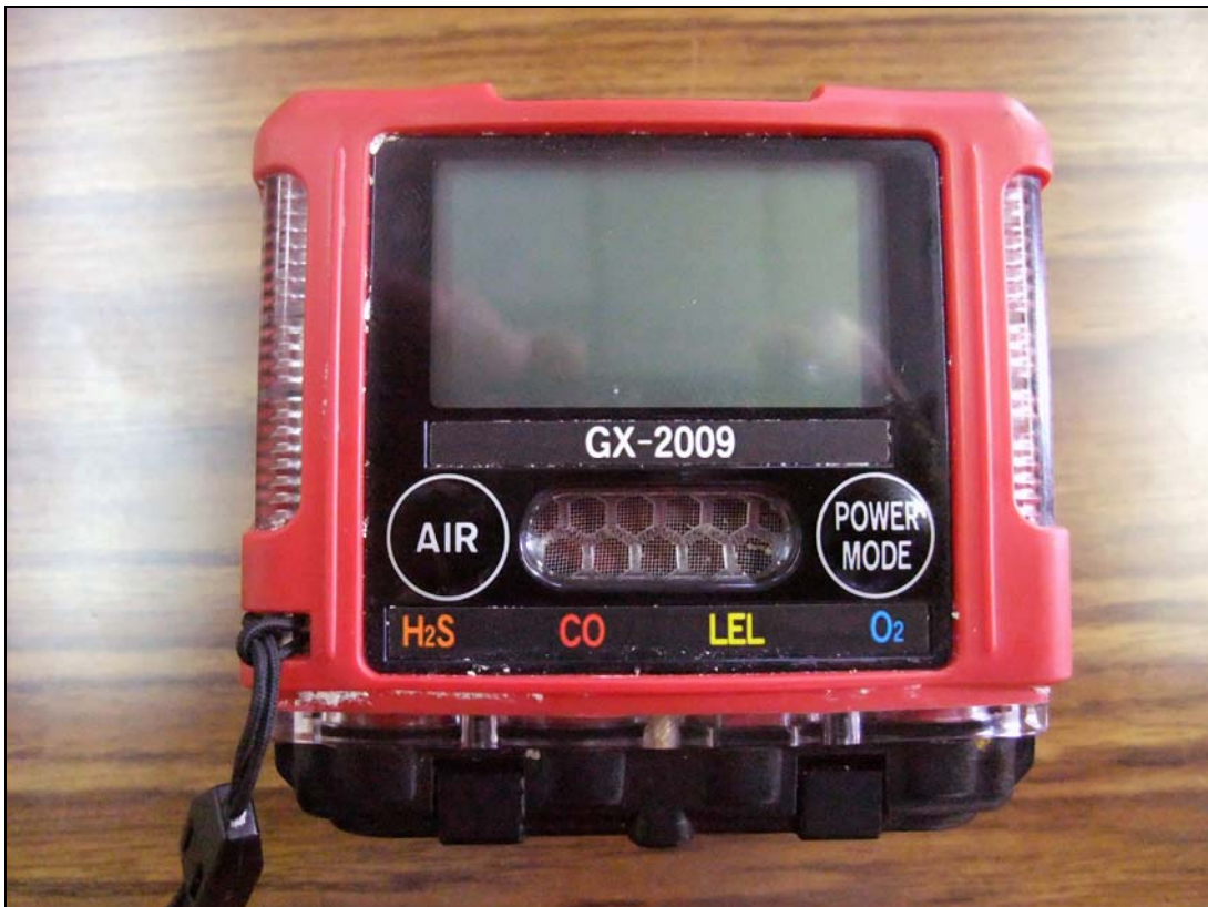
Personenbezogenes Gaswarngerät Riken Keiki GX-2009 (Ex Typ A)
