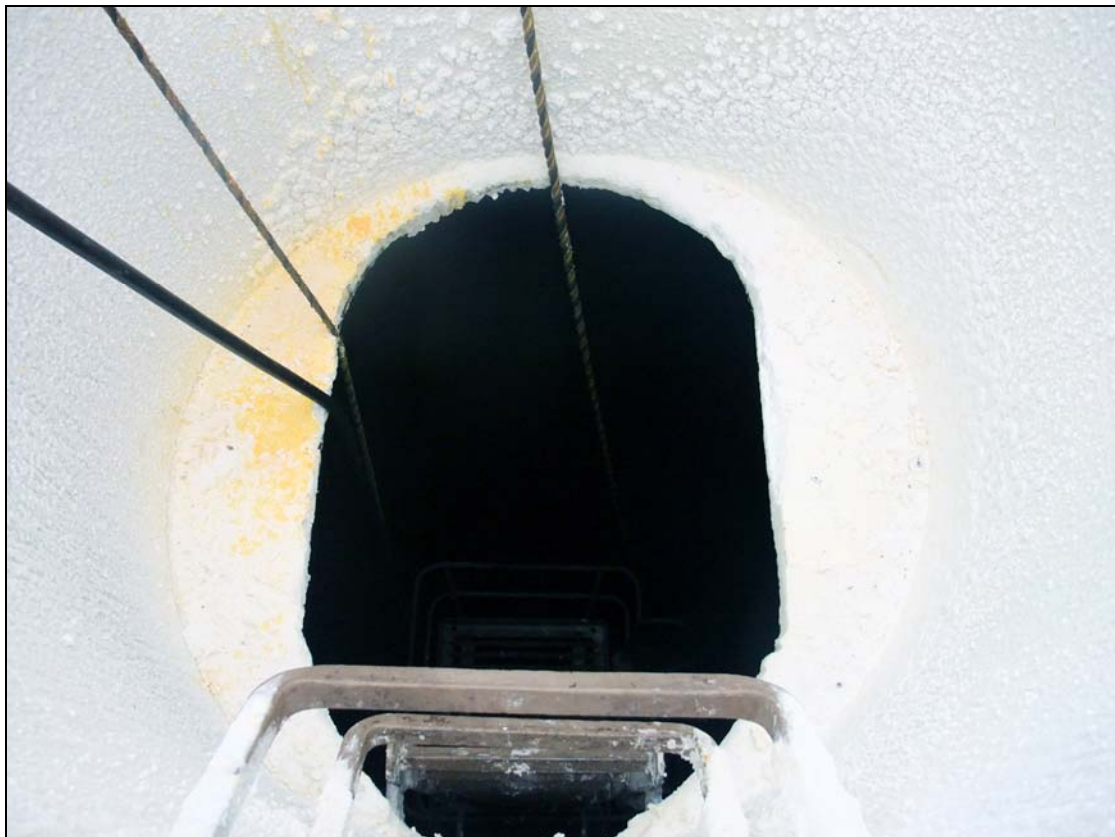
Lukeneinstieg von Ladetank Nr. 2 mit Schicht aus erstarrtem Stearin
