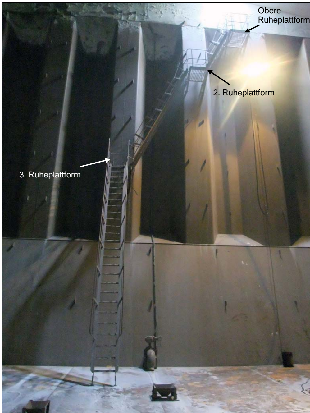
Aufbau des Zugangssystems zu Ladetank Nr. 2
