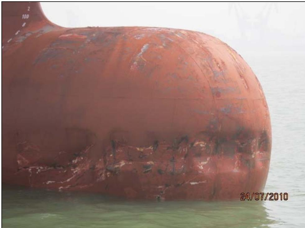
**Abbildung 7: Beschädigung Bugwulst JULA S<sup>15</sup>**
