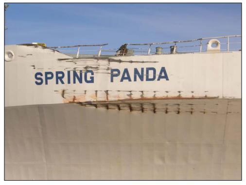
Abbildung 6: Schäden Backdeck MS SPRING PANDA
