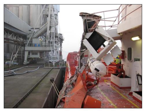
Abbildung 5: Schäden BB-Seite MT LIQUID GOLD
