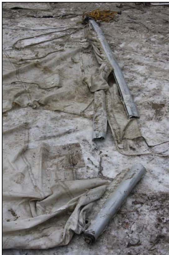
Abbildung 15: Gebrochener Baum der PINGI
