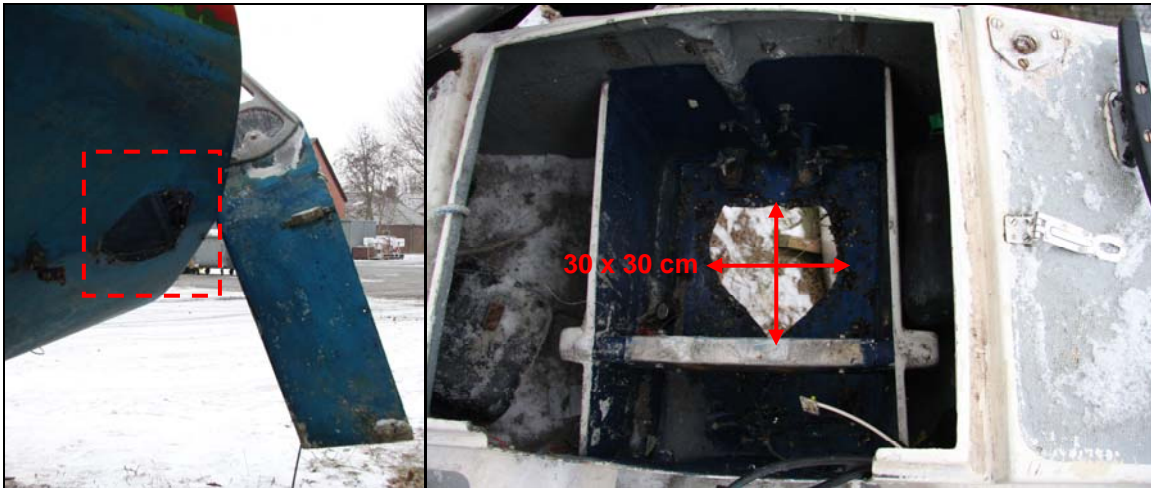
Abbildung 12: Nachträglich eingefügter Durchlass für den Außenbordmotor
