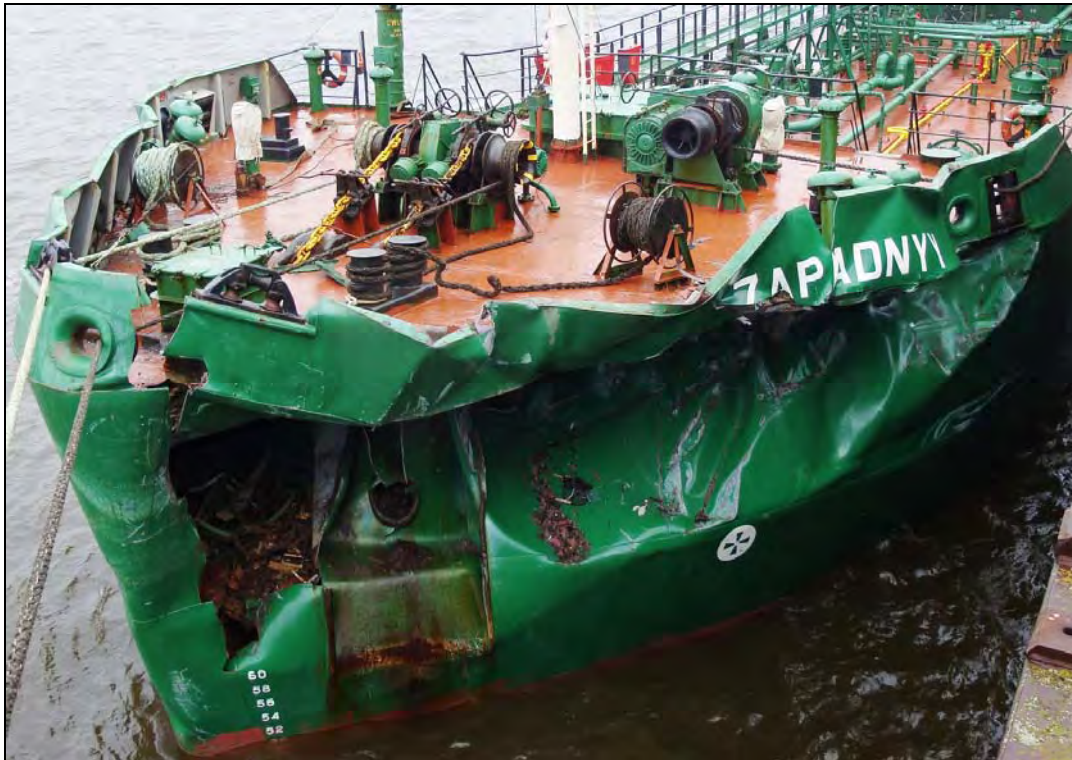
Abbildung 16: Schaden Vorschiff TMS ZAPADNYI (2)
