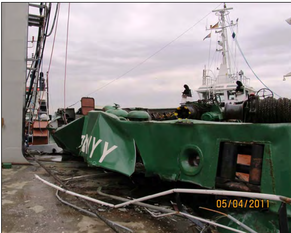
Abbildung 15: Schaden Vorschiff TMS ZAPADNY (1)
