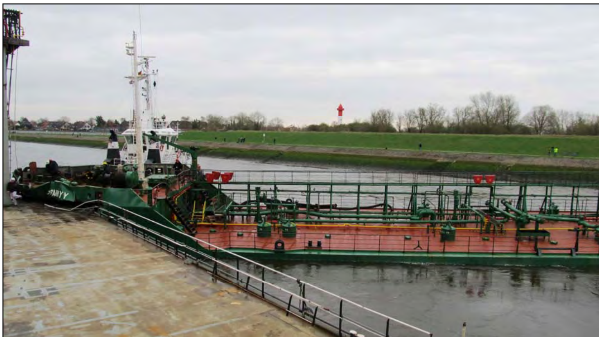
Abbildung 14: In die Stirnseite des Schwimmdocks verkeilt Vorschiff der ZAPADNYI (2)
