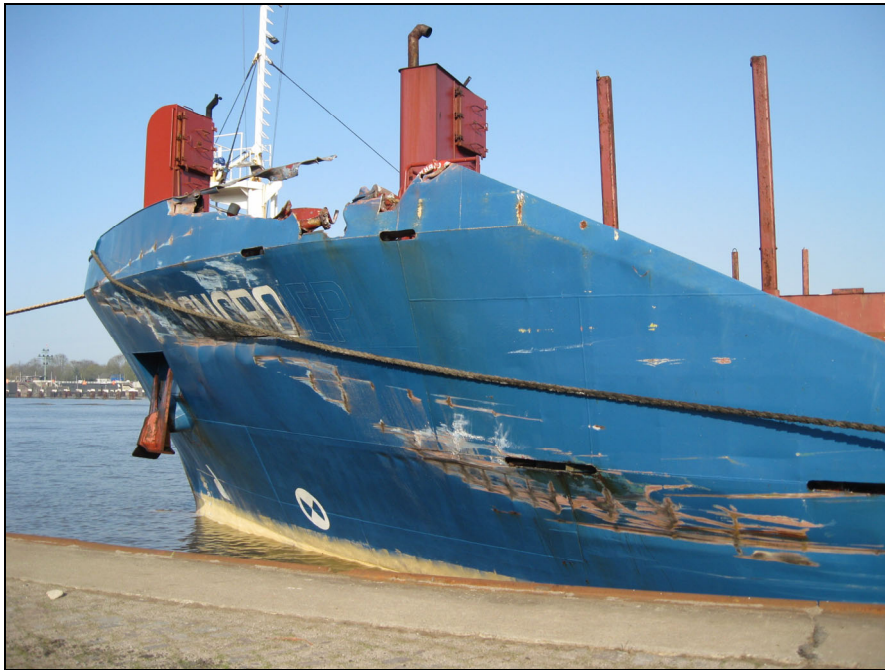
Abbildung 4: Beschädigungen am Bug der SONORO
