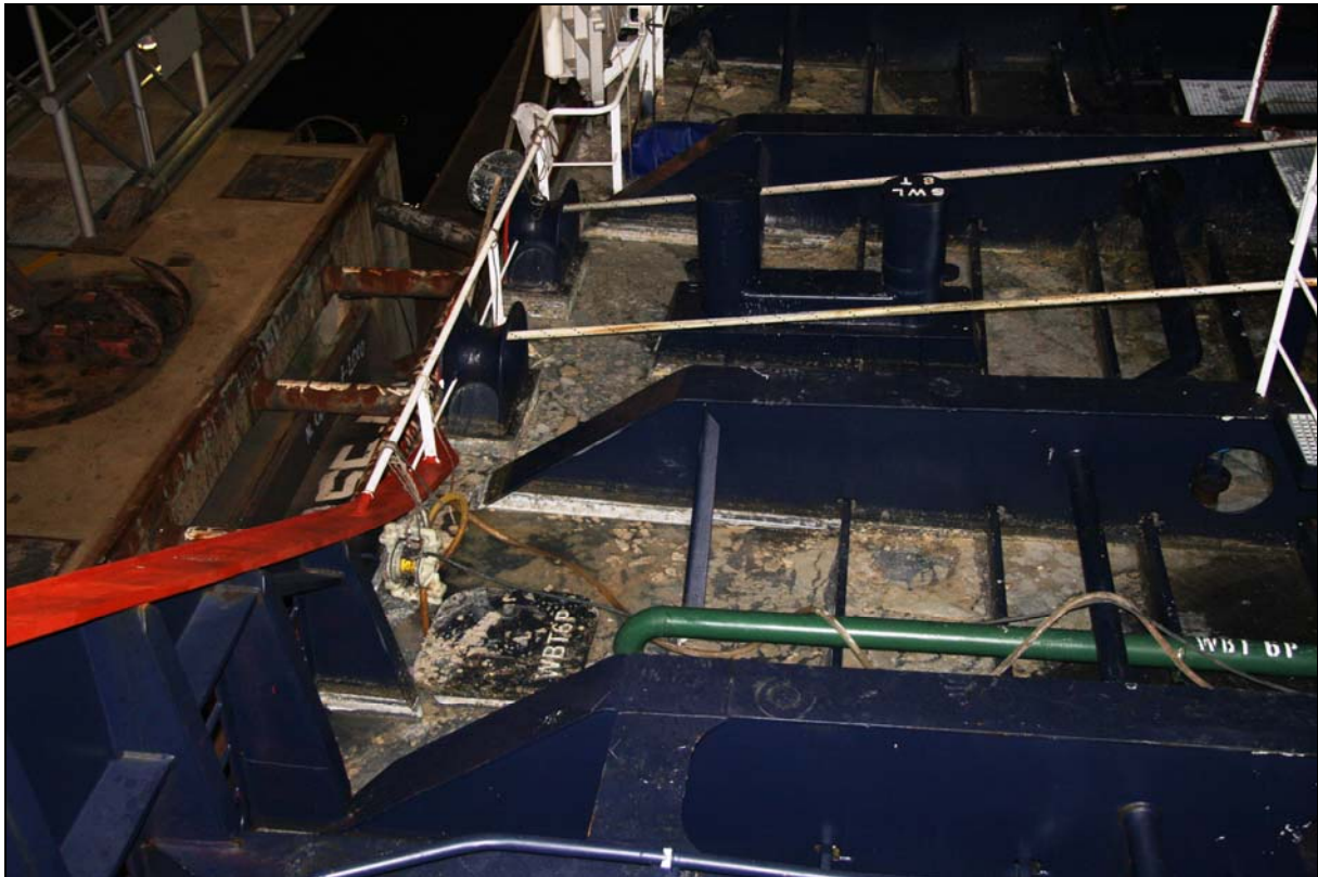
Abbildung 3: Verschmutztes Deck (Backbordseite)
