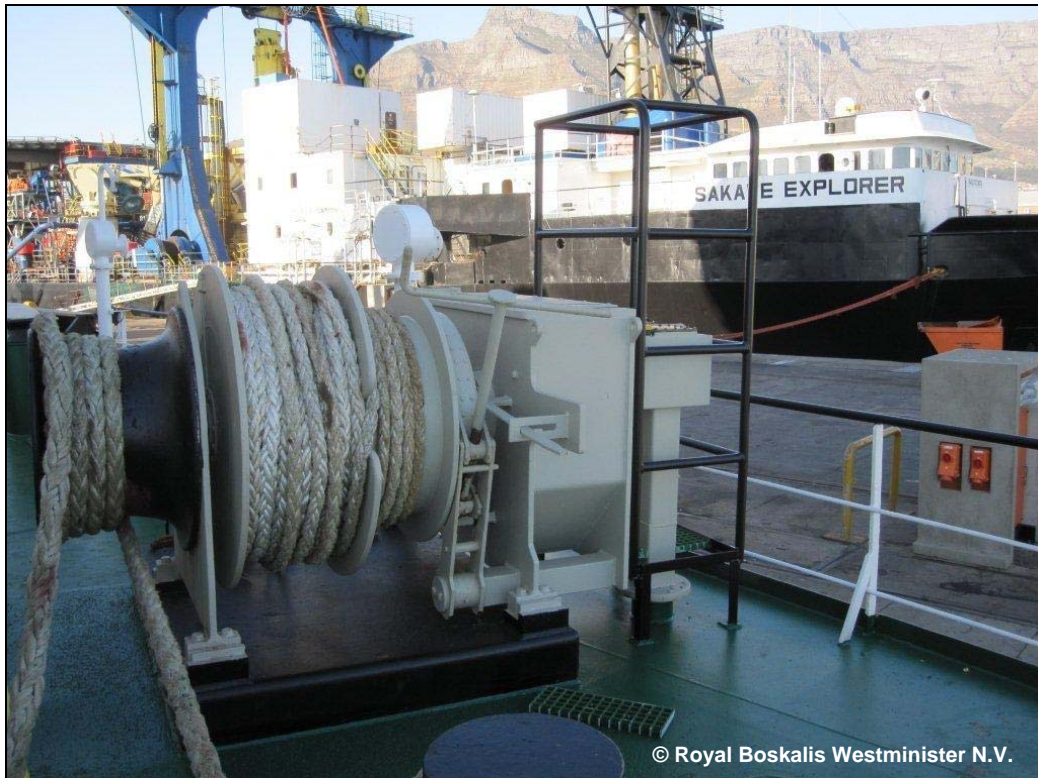
Abbildung 13: Neue Position des Bedienpultes plus Sicherungskäfig (1)
