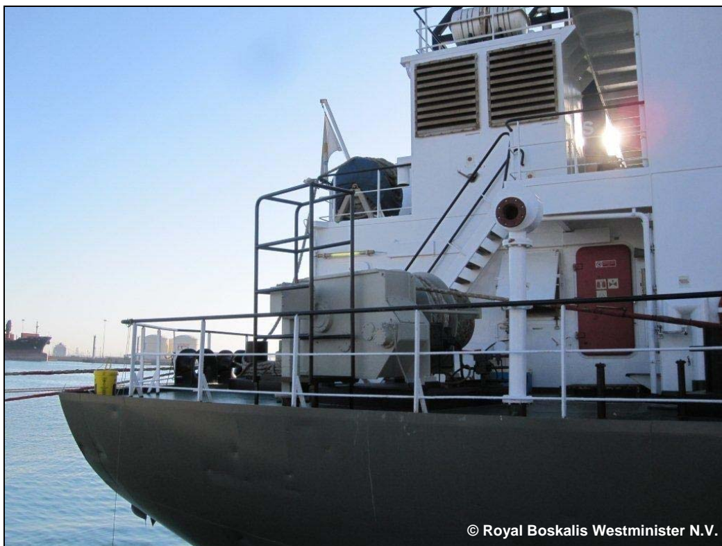
Abbildung 14: Neue Position des Bedienpultes plus Sicherungskäfig (2)
