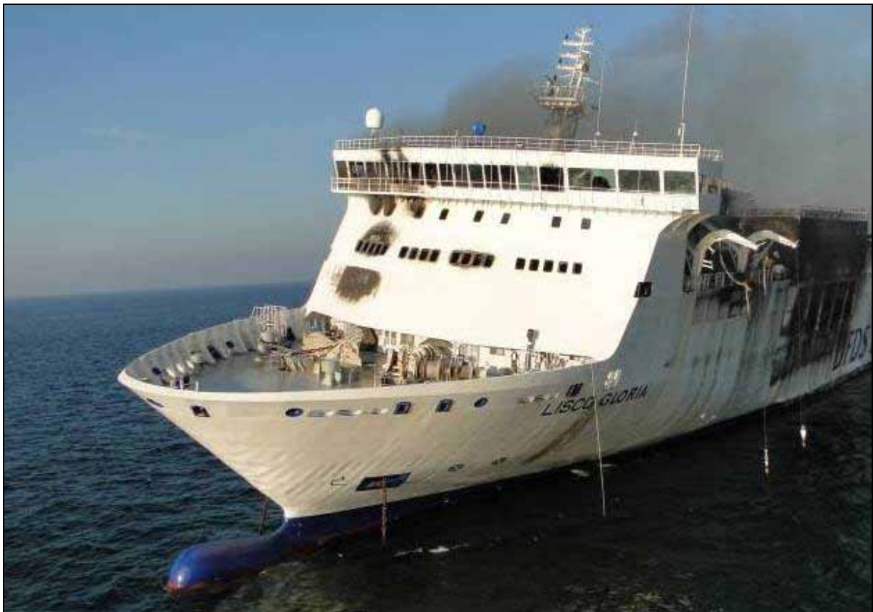
Abbildung 14: Nahezu unbeschädigtes Vorschiff der LISCO GLORIA
