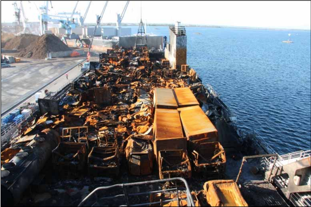
Abbildung 9: Oberdeck nach dem Brand, Blick nach achtern
