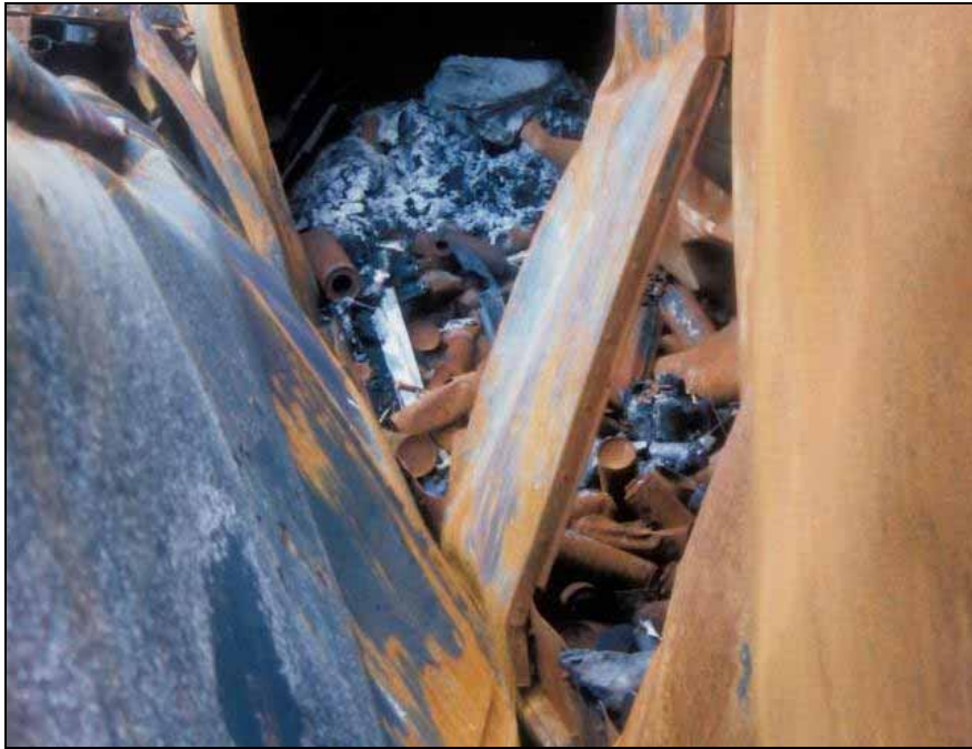
Abbildung 54: Ladungsreste (Spraydosen) eines Gefahrguttransportes
