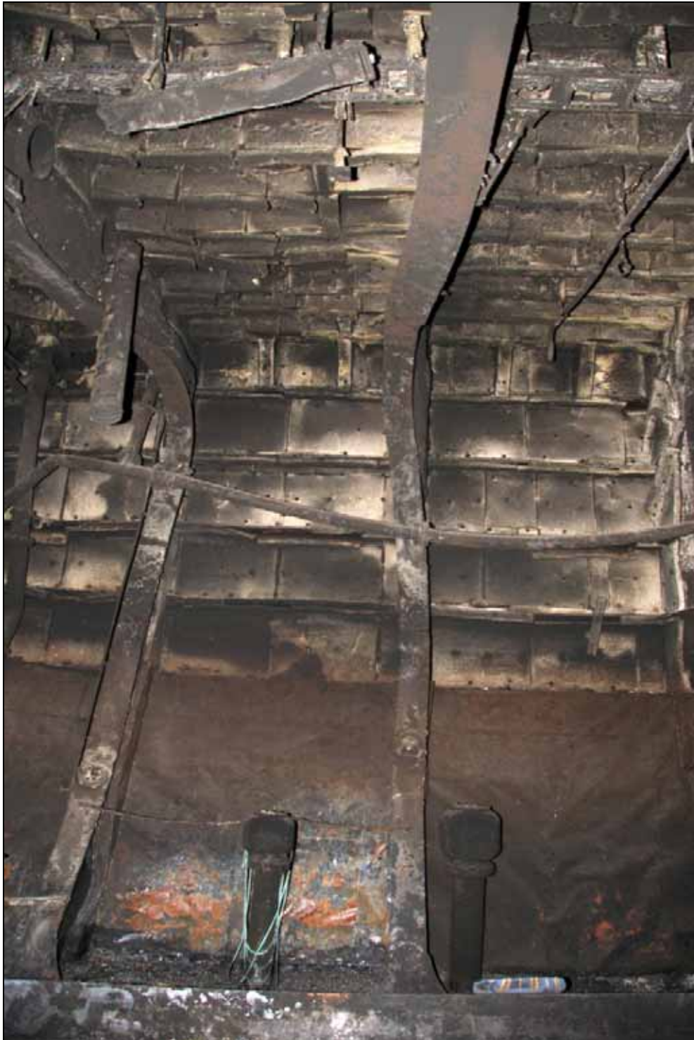
Abbildung 59: Überreste der A-60 Isolierung auf Deck 4
