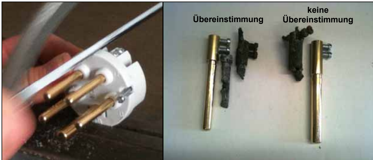
Abbildung 97: Zuordnung der asservierten Kontaktstifte im Laborversuch
