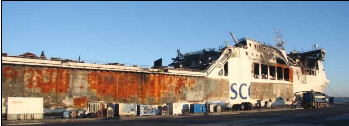
Abbildung 13: LISCO GLORIA nach dem Brand längsseits der Pier in Munkebo
