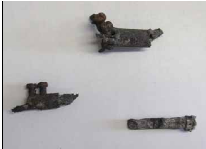
Abbildung 38: Fragmente der elektrischen Kontakte einer Kupplungsdose bzw. eines Steckers
