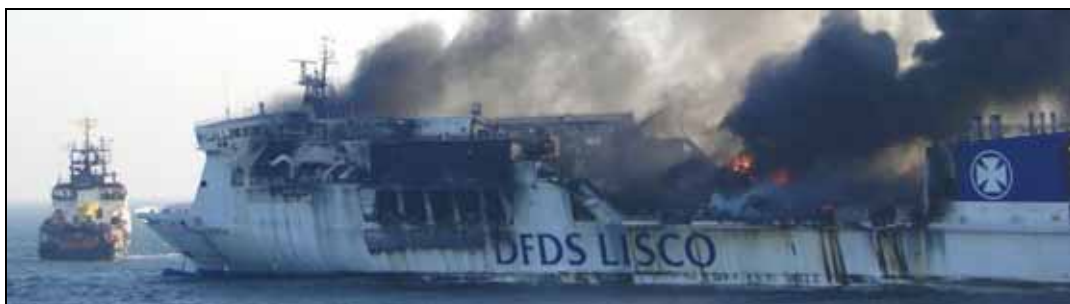
Abbildung 116: Brand auf dem Wetterdeck und teilweise kollabierte Aufbauten, aufgenommen am 9. Oktober 2010 um 16:45 Uhr
