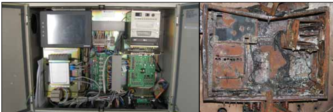
Abbildung 122: VDR Hauptspeicher im Originalzustand (Vergleichsmodell) und nach dem Brand
