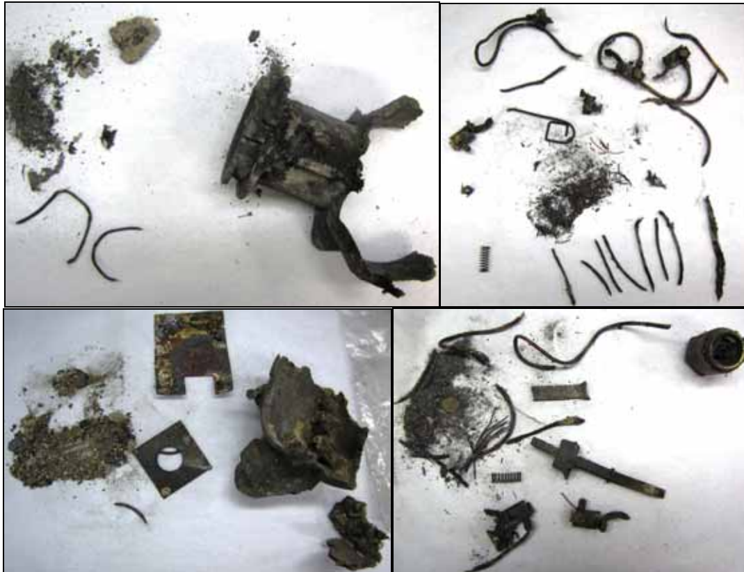
Abbildung 94: Überreste von zwei schaltbaren Mehrfachsteckdosen
