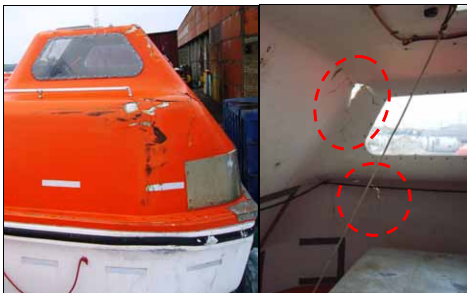
Abbildung 28: Heckschaden an Rettungsboot 1, Sicht von außen und von innen
