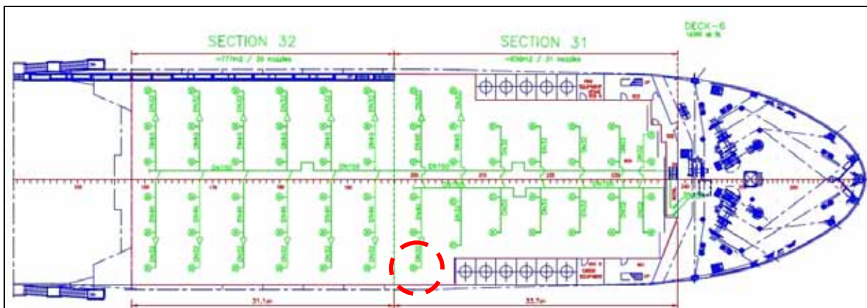
Abbildung 79: Sprühflutsektionen auf dem Oberdeck der LISCO GLORIA
