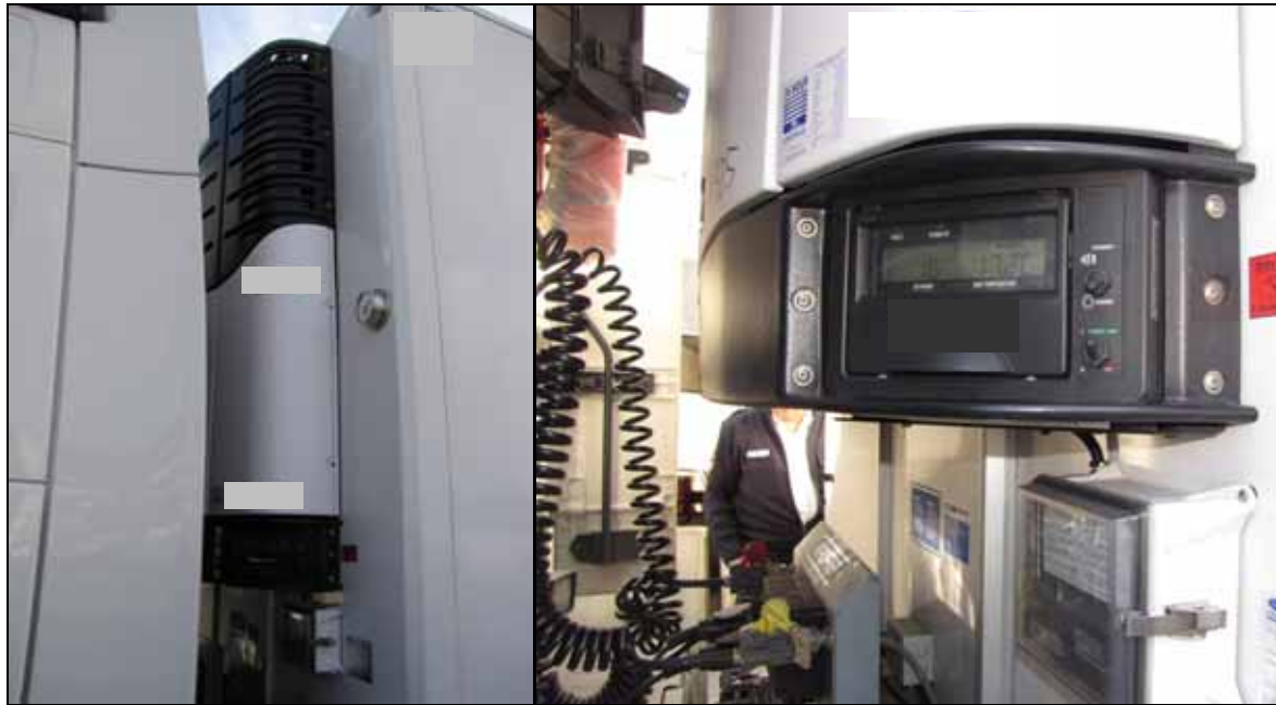
Abbildung 53: Kühlaggregat, angebracht zwischen Fahrerhaus und Trailer
