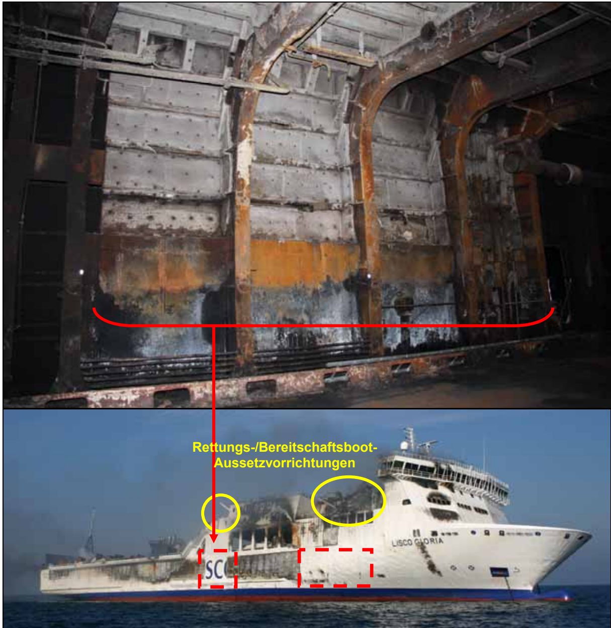
Abbildung 62: Verstärkte Isolierung im Bereich der Rettungsmittel
