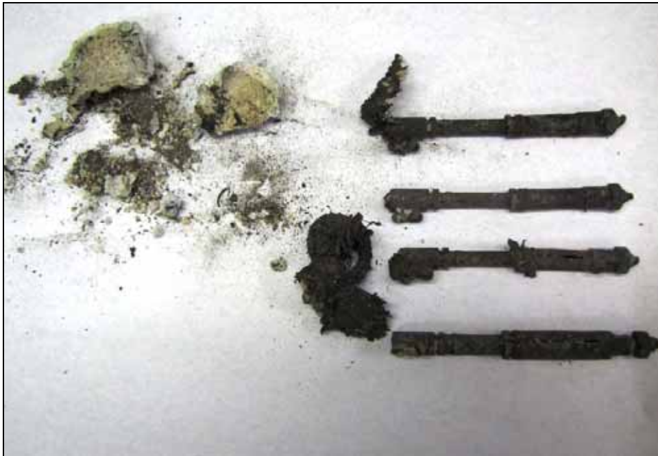
Abbildung 95: Überreste der Kontaktmaterialien der Steckverbindungen
