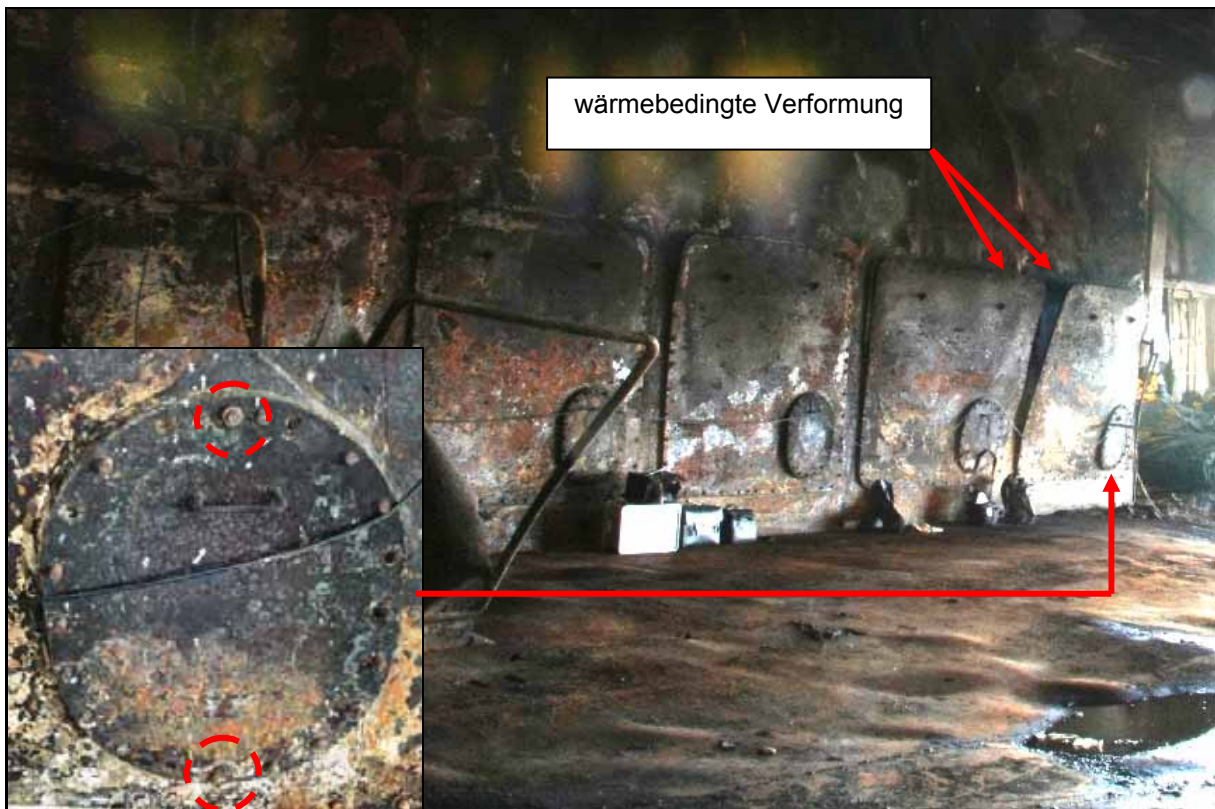
Abbildung 75: Zugänge zu den Ventilationsschächten auf Deck 6 - Steuerbordseite
