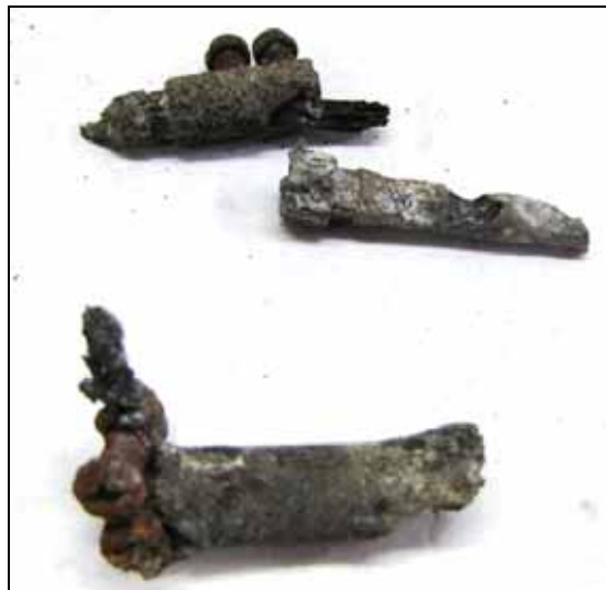
Abbildung 96: Reste der Kontaktstifte, die zwischen Lkw und Trailer gefunden wurden
