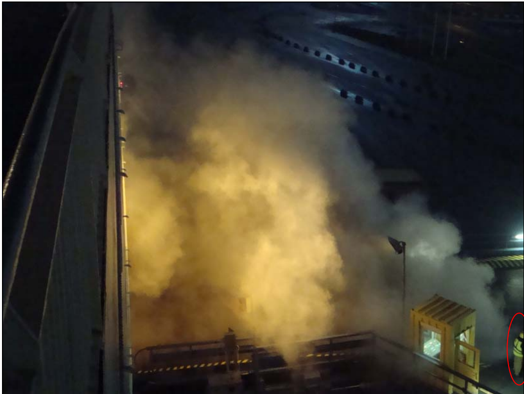
Abbildung 15: Rauchentwicklung außerhalb des Schiffes nach dem Öffnen des Bugseitentores auf Deck 4 6
