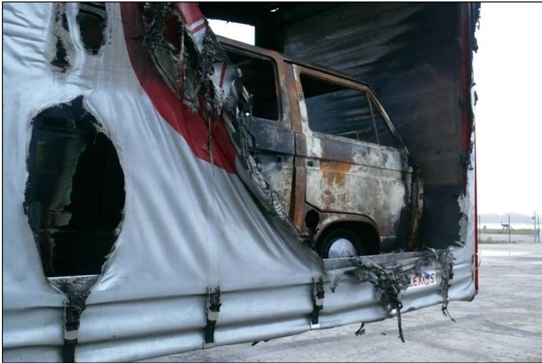
Abbildung 12: Brandbeschädigter Sattelanhänger mit VW-Transporter
