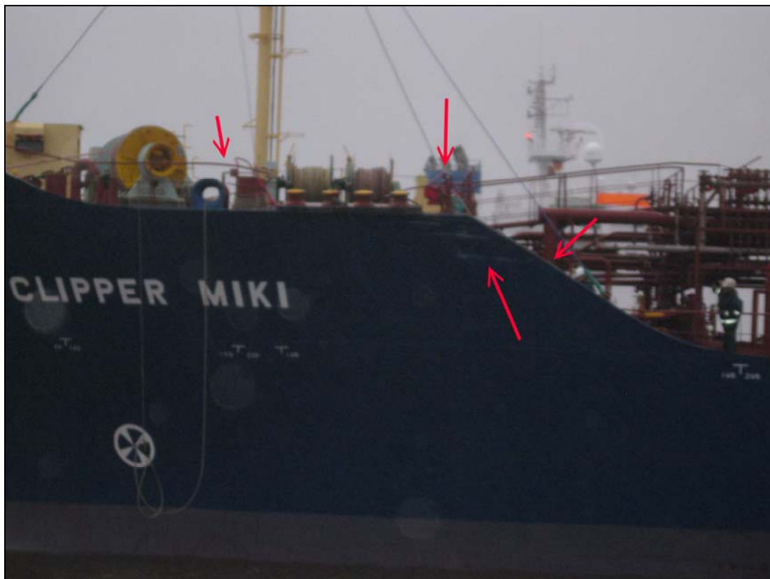
Abbildung 9: CLIPPER MIKI Schadensbereich Vordeck
