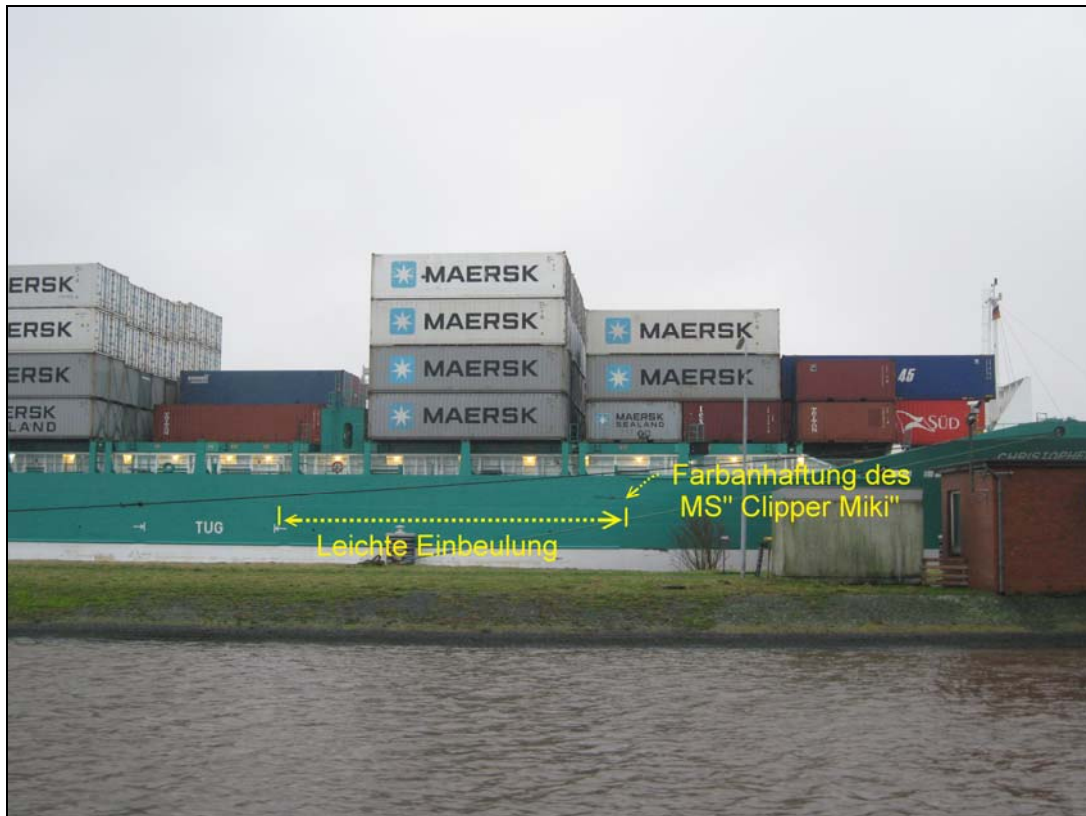
Abbildung 29: CHRISTOPHER Übersicht der Schäden vorn
