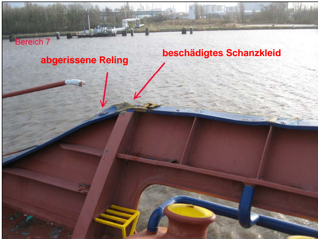
Abbildung 23: CLIPPER MIKI Schadensbereich 7
