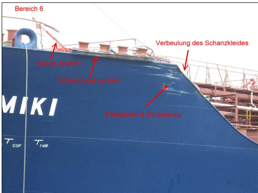
Abbildung 20: CLIPPER MIKI Schadensbereich 6
