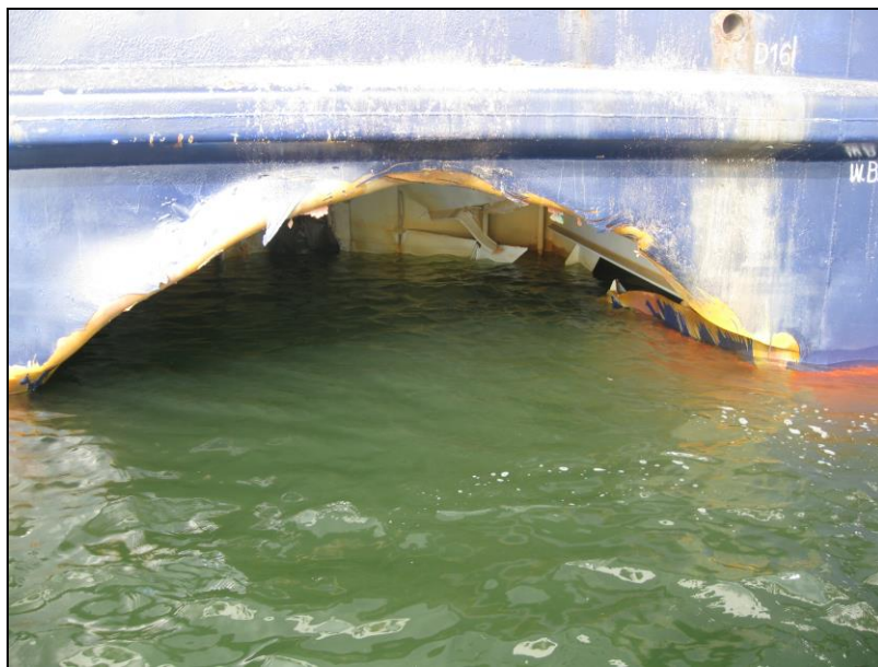
Abbildung 12: Loch auf Höhe der Wasserlinie in der Bordwand der URD
