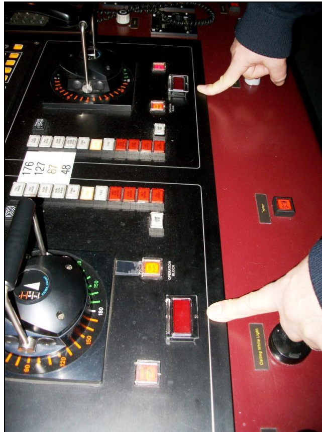
Abbildung 27: Neue Anordnung der „Crash stop“-Tasten unterhalb der Steuerhebel
