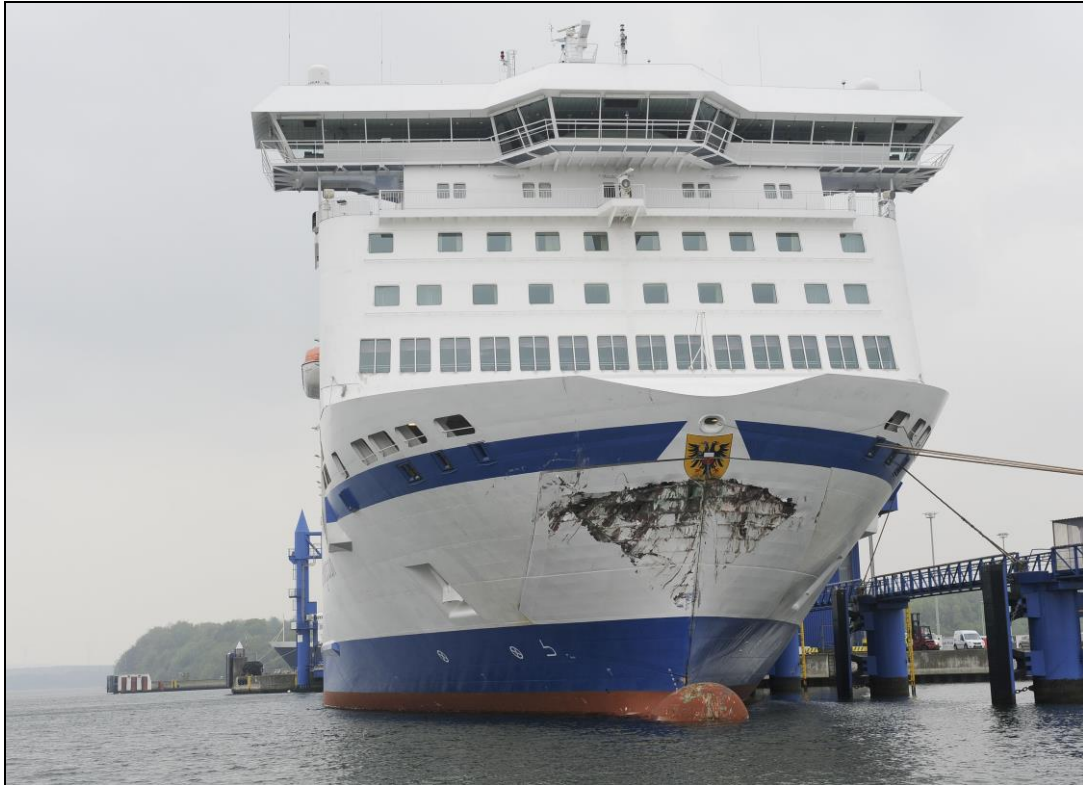
Abbildung 9: Schaden am Bugvisier der NILS HOLGERSSON
