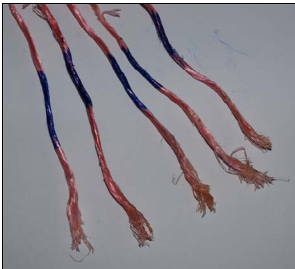
Abbildung 14: Schädigung vor dem Bruch
