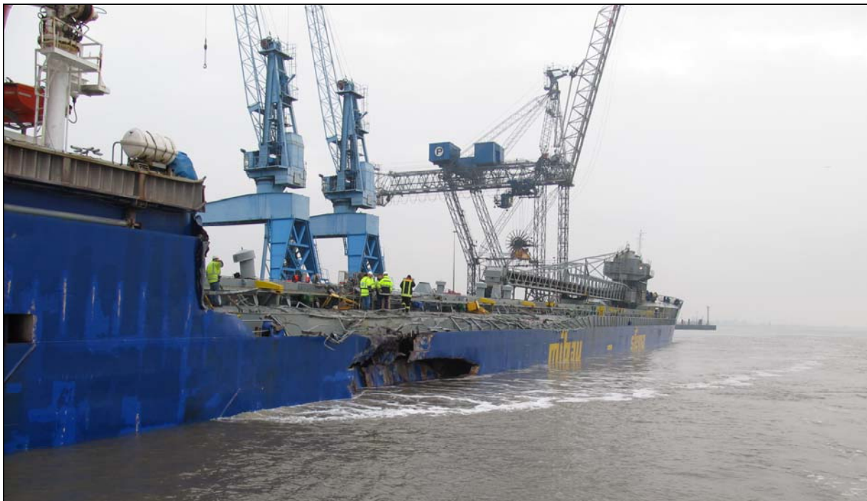
Abbildung 8: Wassereintritt an der Steuerbordseite der SPLITTNES
