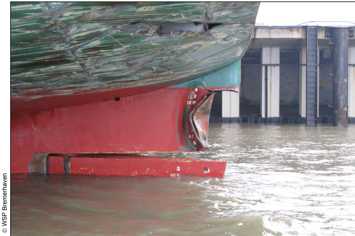
Abbildung 5: Schäden im Ruderbereich der MOL EFFICIENCY
