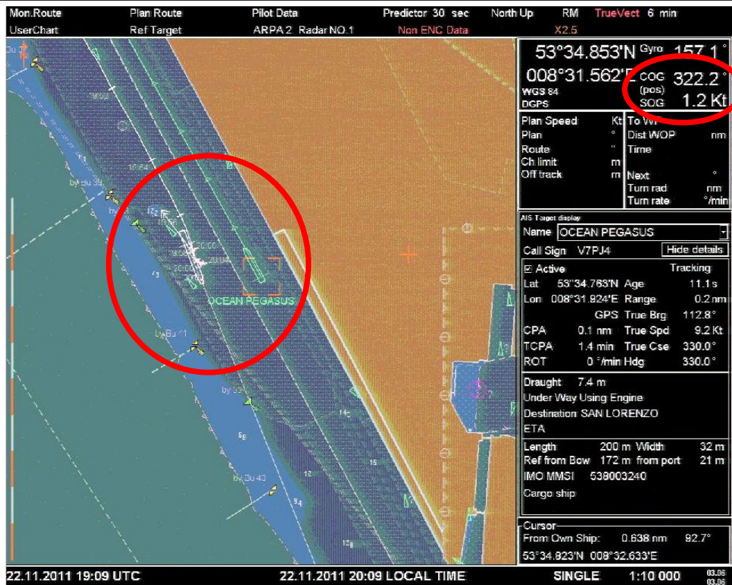
Abbildung 32: Elektronische Seekarte der MOL EFFICIENCY um 20:09 Uhr
