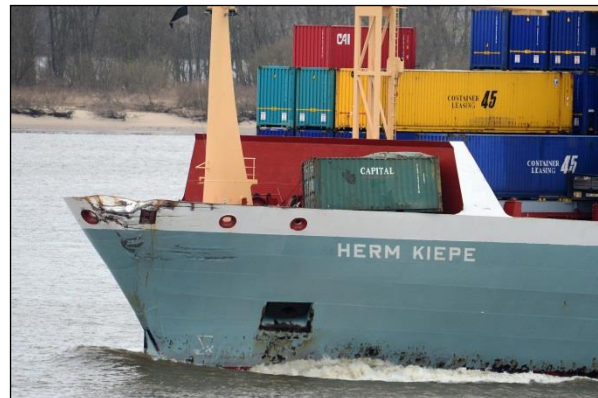
Abbildung 5: Schäden HERM KIEPE
