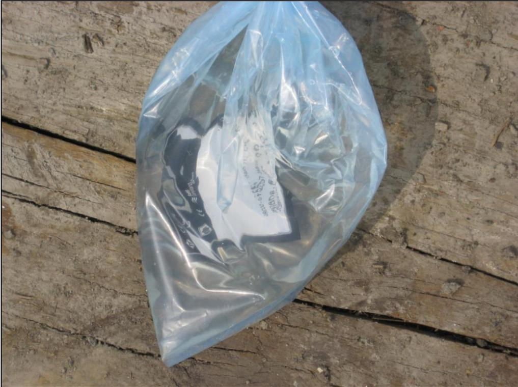
Abbildung 12: CompactFlash-Speicherkarte aus der Zentraleinheit des Schiffsdatenschreibers in der mit Wasser gefüllten Transporttüte
