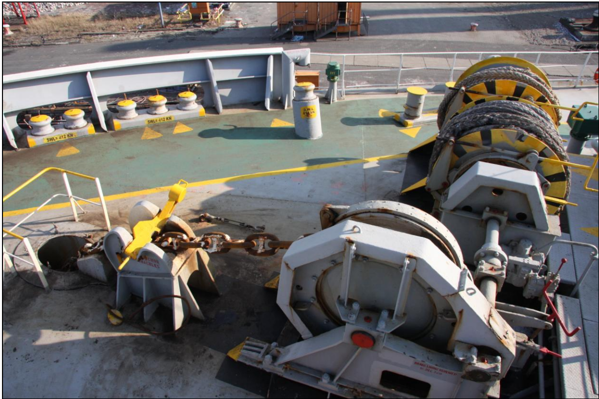
Abbildung 27: Steuerbord-Ankerwinde und Ankerkette auf dem Vorschiff der CORAL ACE
