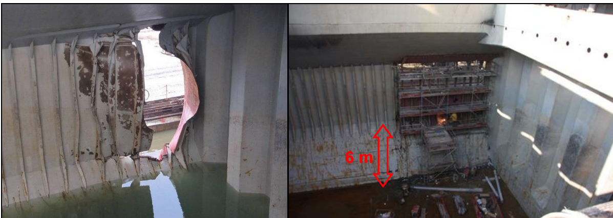
Abbildung 18: Beschädigter Laderraum Nr. 3
