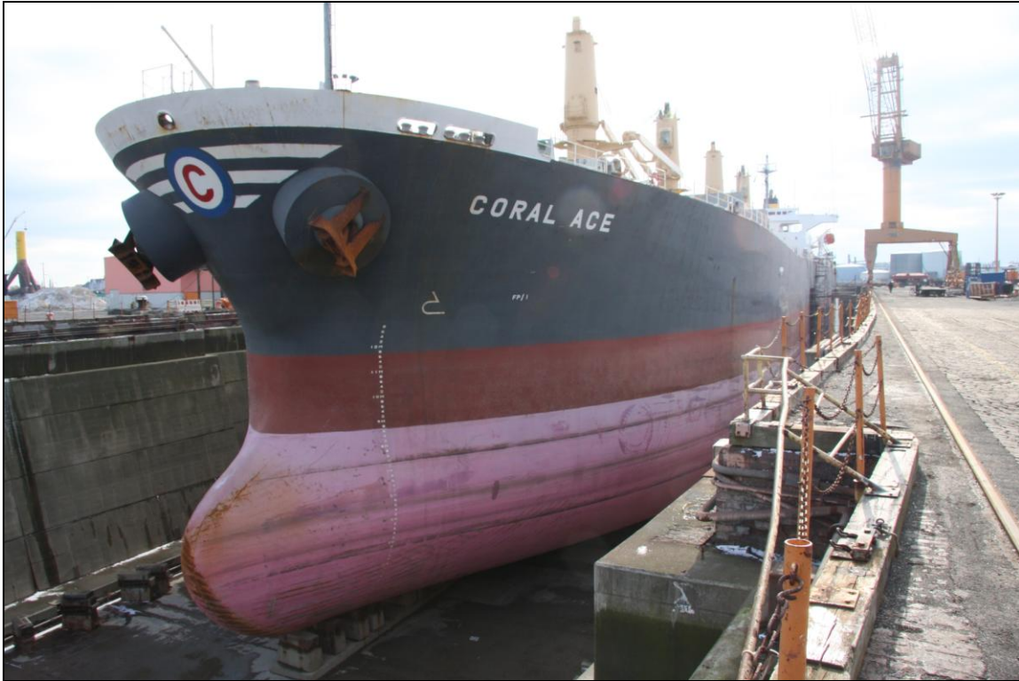
Abbildung 29: Patentanker der CORAL ACE
