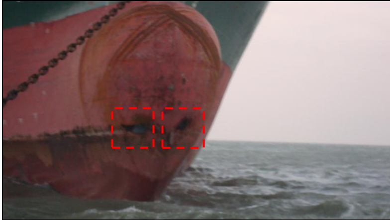
Abbildung 20: Beschädigter Wulstbug der LISA SCHULTE
