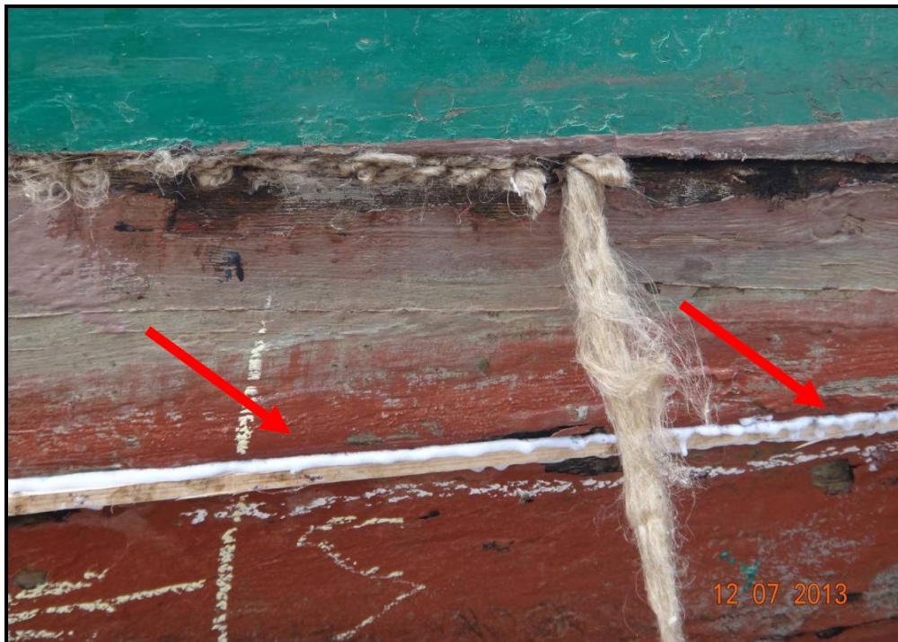
Abbildung 9: Verleimung von Holzleisten in Längsnähten
