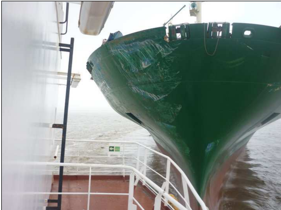
Abbildung 17: Farbabschürfungen im Bereich des Vorschiffs der CSAV PETORCA 23
