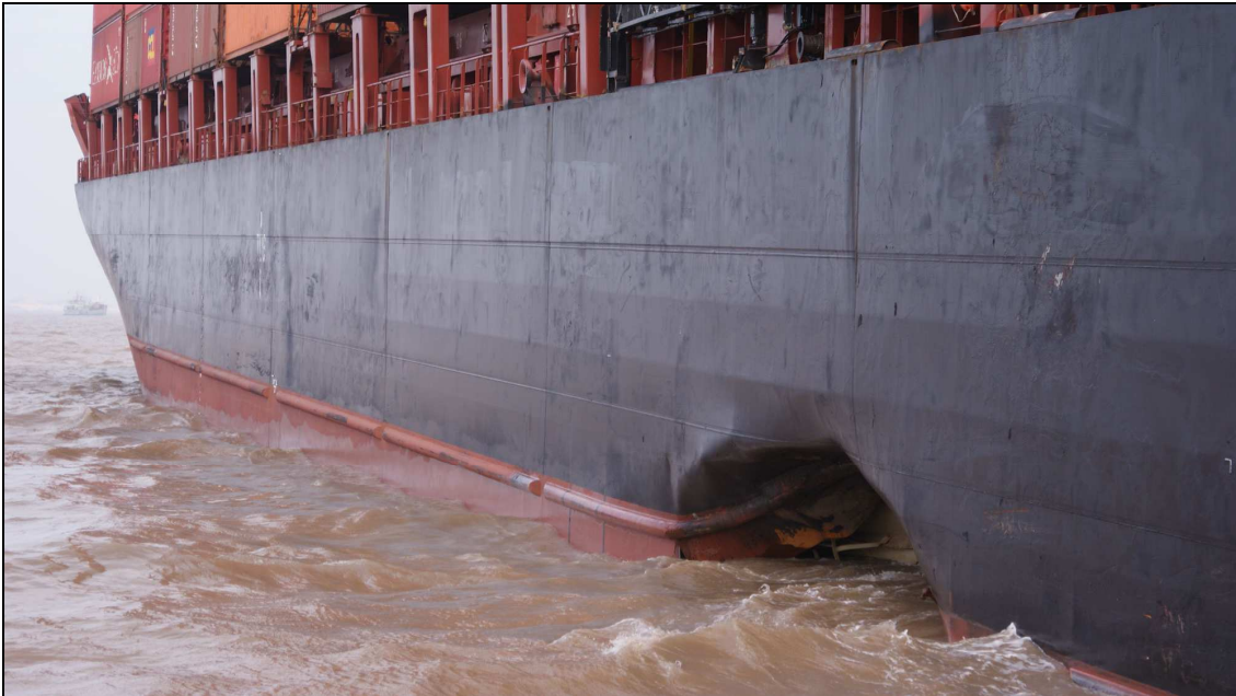
Abbildung 12: Außenhautbeschädigung CCNI RIMAC
