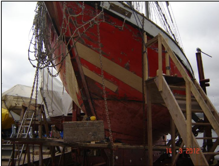
Abbildung 4: Erneuerte Planken Backbord
