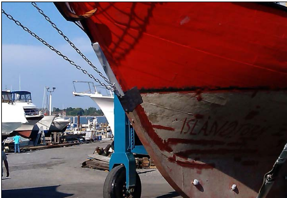
Abbildung 6: Stevenbeschlag mit Blei vernagelt
