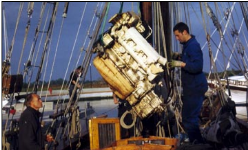
Abbildung 7: MTU 147 PS, Ausbau wegen Überholung Juni 2004
