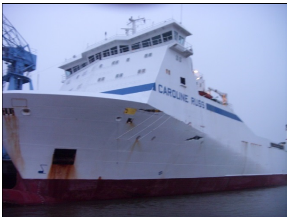
Abbildung 4: Bugschaden CAROLINE RUSS
