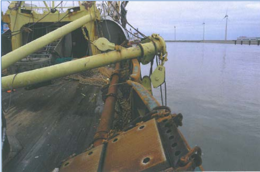
Abbildung 7: Schäden an Steuerbordseite und Fanggeschirr
