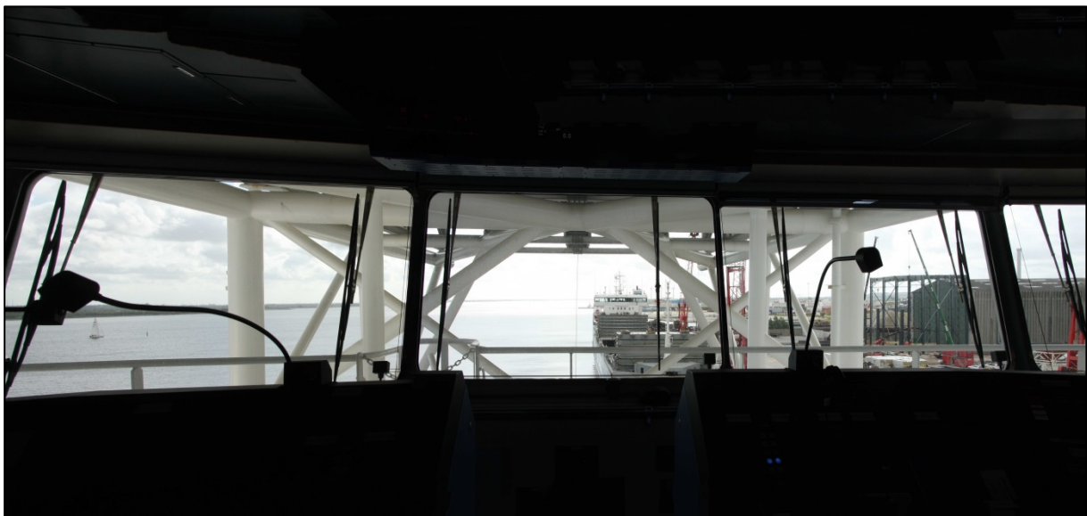
Abbildung 9: Sichtbehinderungen am Hauptsteuerstand
