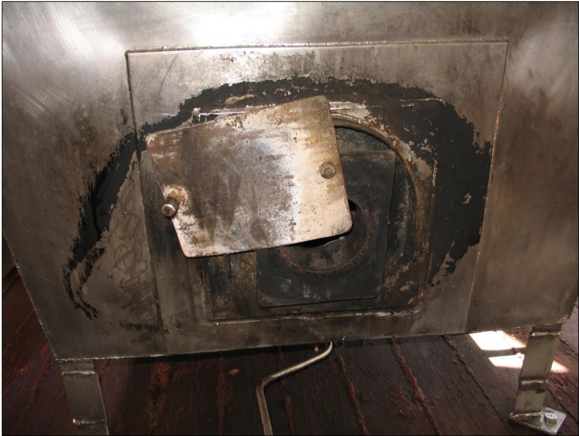
Abbildung 14: Zündöffnung mit Verschlussblech
