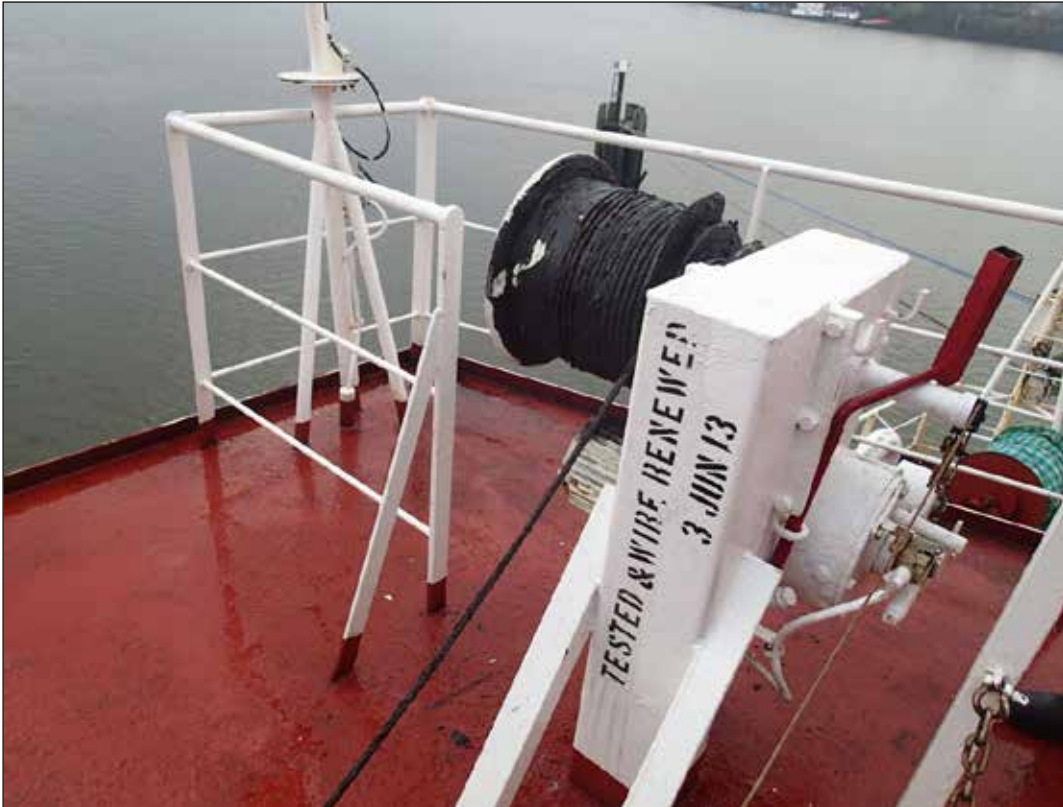
Abbildung 13: Winde mit Kennzeichnung des letzten Seiltauschs
