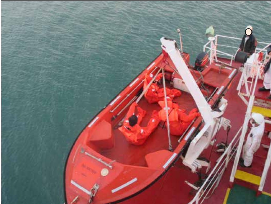
Abbildung 4: Beginn des Manövers, Davitanlage ist noch eingeschwenkt
