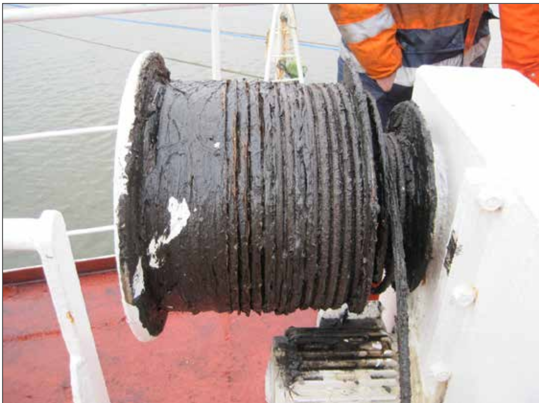
Abbildung 15: Winde mit stark gefettetem Seil
