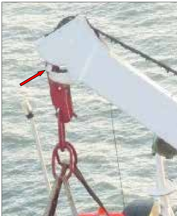
Abbildung 35: Unmittelbar vor dem Unfall: Der Haken kann nicht weiter einschwenken, da die Seilklemme gegen die obere Umlenkrolle liegt
