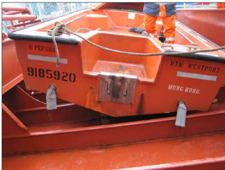
Abbildung 21: Bereitschaftsboot – Ansicht von hinten mit fehlendem Außenbordmotor
