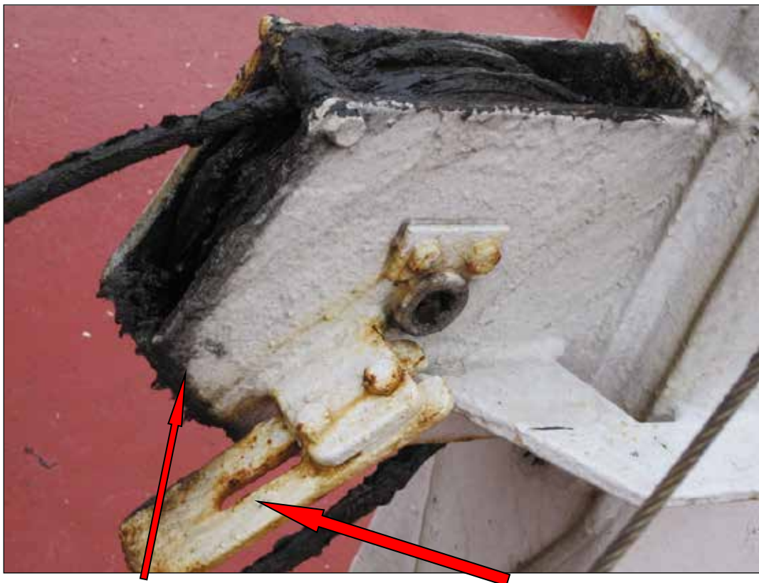
Abbildung 31: Gegenstück für Endlagenschalter. Daneben Auflagerfläche des Davits für die Endlage.
