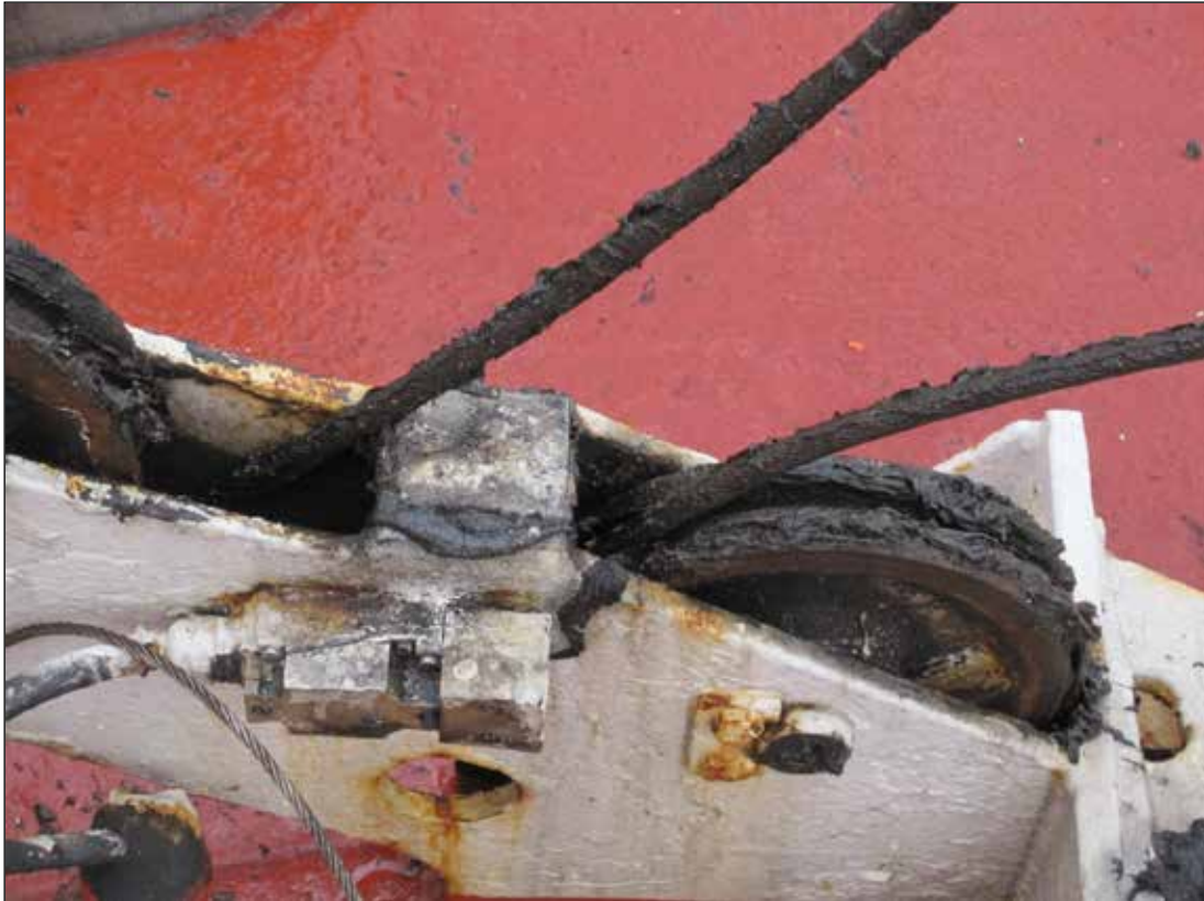
Abbildung 14: Fett auf Seil, Umlenkrolle und im Gehäuse
