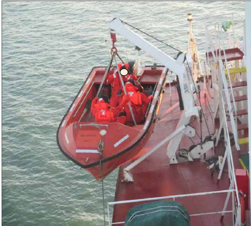
Abbildung 7: Boot wird mit Davit eingeschwenkt
