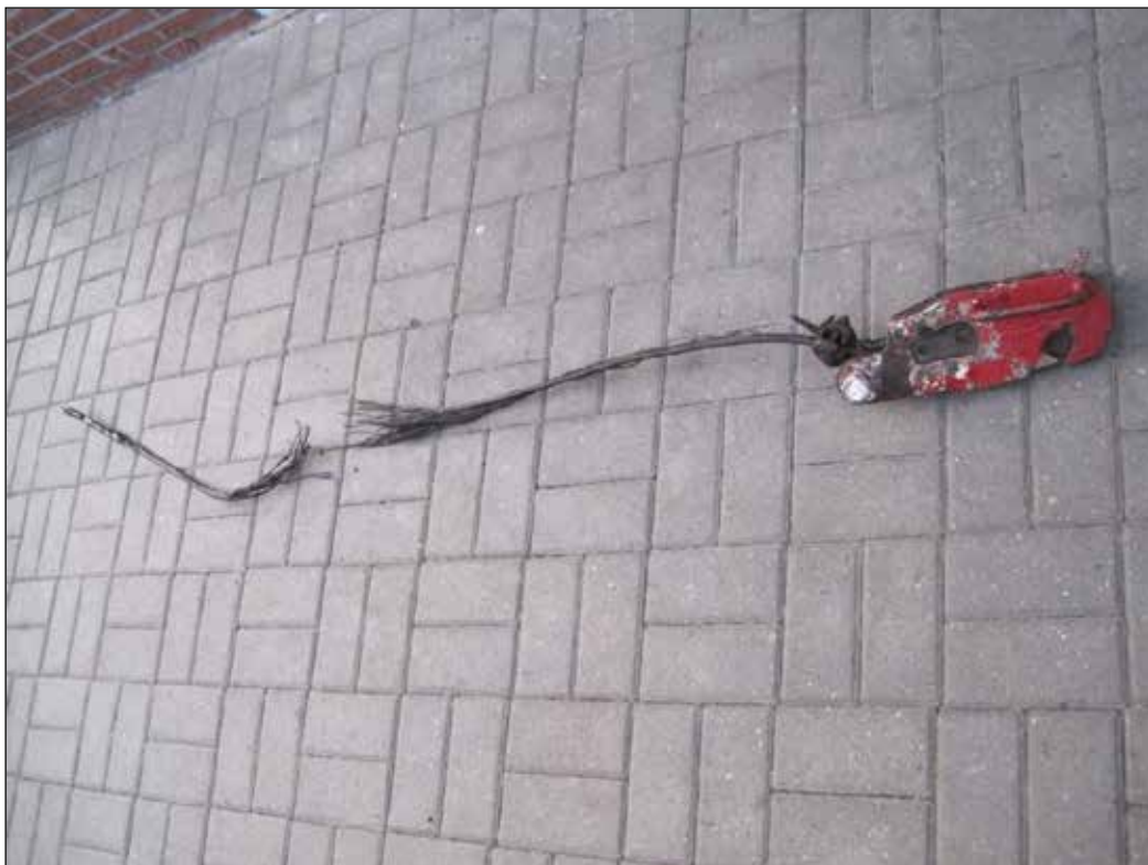
Abbildung 22: Haken mit gerissenen Seilenden
