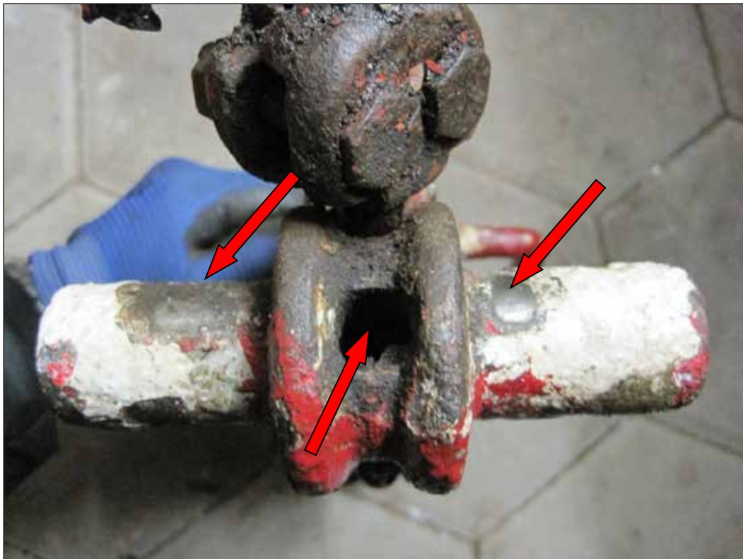
Abbildung 24: Falsch montiertes Seil am Haken. Das \varnothing 12 mm-Seil hätte durch das mittlere Loch in den Haken eingeführt werden müssen. Seitlich sind die Druckstellen unter 36^\circ aus der vertikalen Ebene erkennbar.
