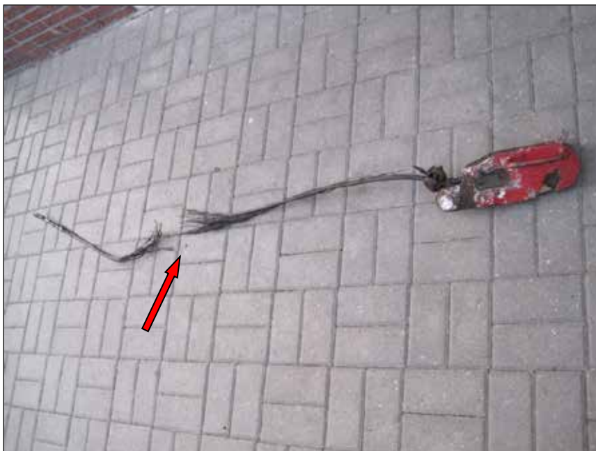
Abbildung 29: Position des Seilbruches 700 mm oberhalb des Hakens.
