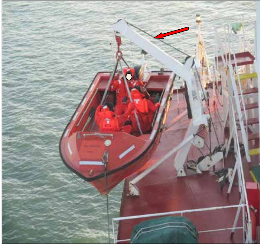
Abbildung 28: Ungefähre Position des Seilbruchs unmittelbar vor dem Unfall
