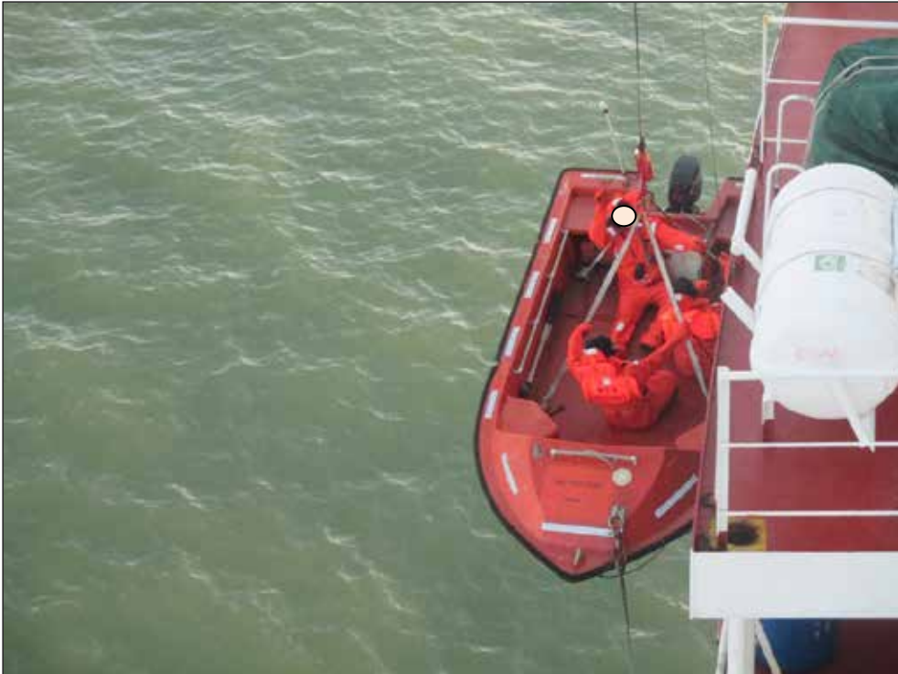
Abbildung 6: Boot wird aus dem Wasser bis zum Erreichen des Davitkopfes hoch gezogen
