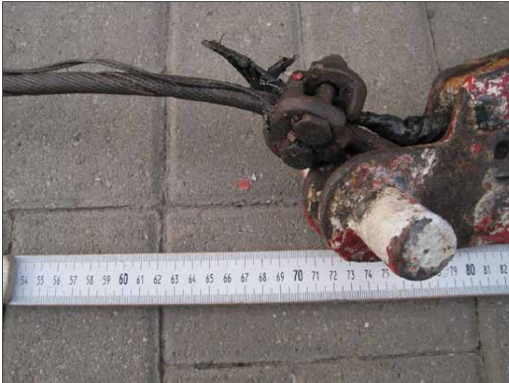
Abbildung 23: Schräg laufende Seilklemme
