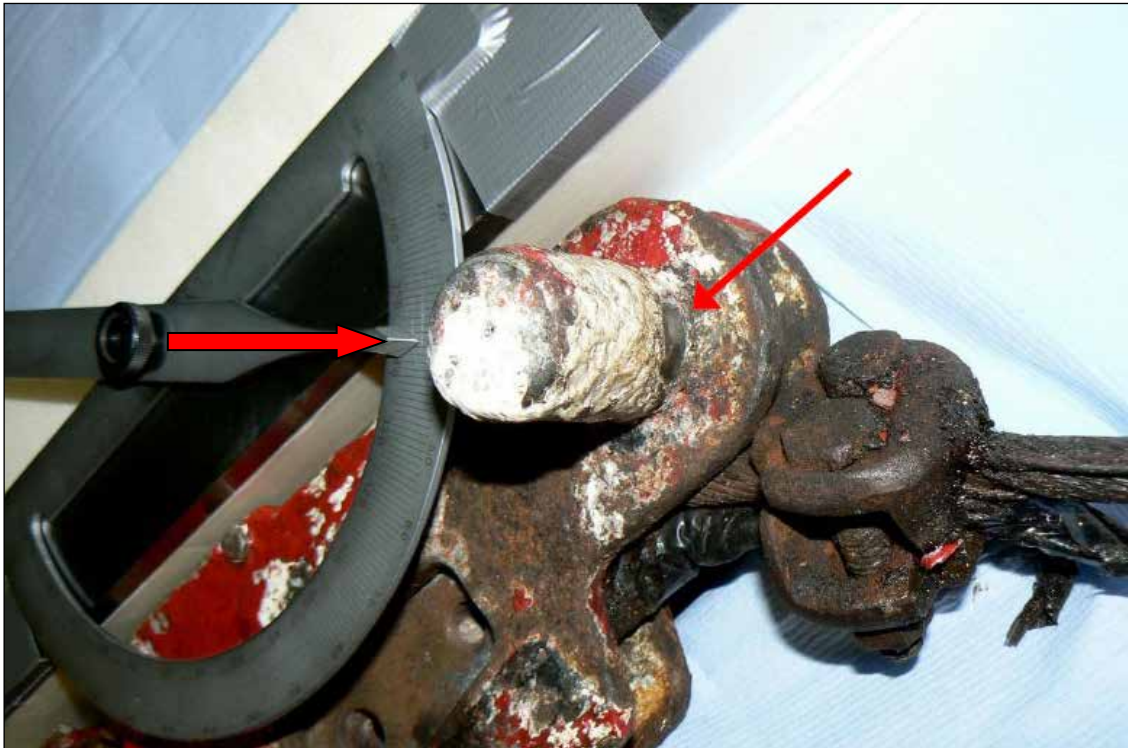
Abbildung 26: Ermittlung des Winkels der Anlage-Druckpunkte des Hakens am Davitkopf von 36°
