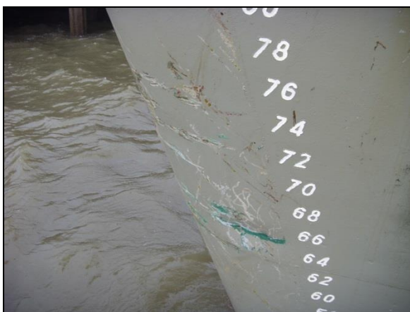
Abbildung 6: Bugschaden BARENT ZANEN
