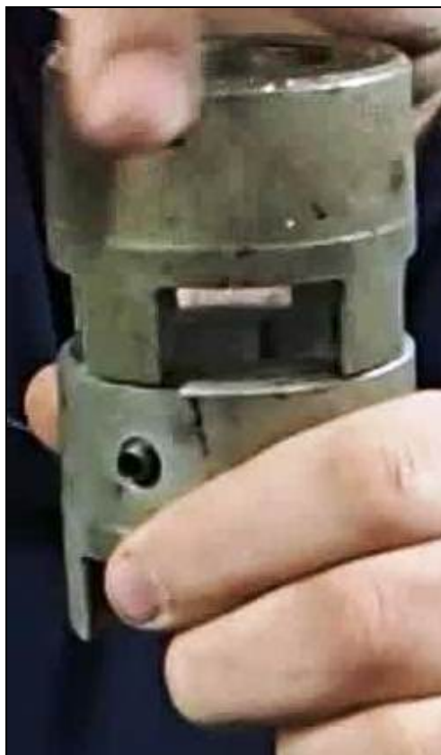
Abbildung 15: Kupplung ohne Metallkrone
