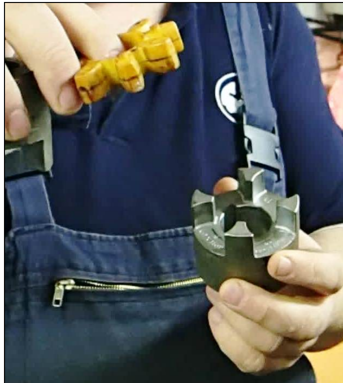
Abbildung 13: Kupplungshälfte mit entnommenem Plastikpuffer
