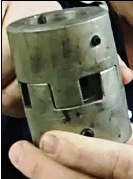
Abbildung 14: Kupplung ohne Plastikpuffer
