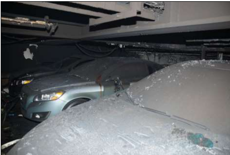
Abbildung 50: Unterschiedliche Schadensspuren an benachbarten Fahrzeugen
