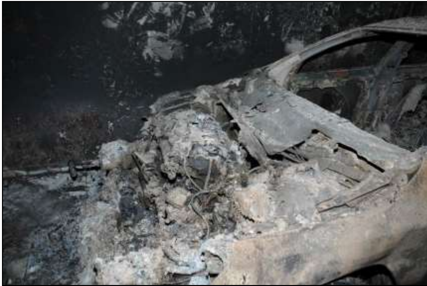
Abbildung 55: Durch Metallbrand komplett zerstörter Motorraum eines PKW
