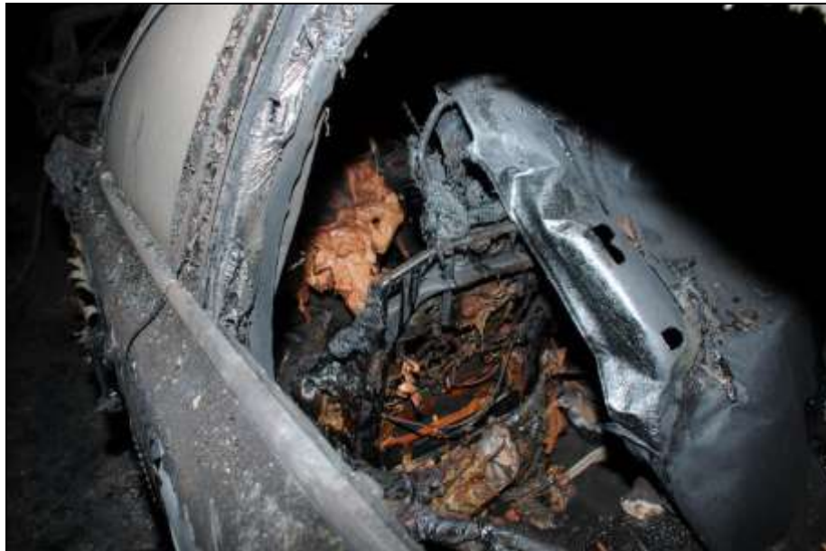
Abbildung 60: Ausgelöste Airbag-Fragmente im Innenraum eines PKW
