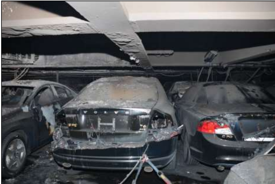
Abbildung 51: Zerstörte Kunststoffteile (hier Rücklichter) an den Fahrzeugen
