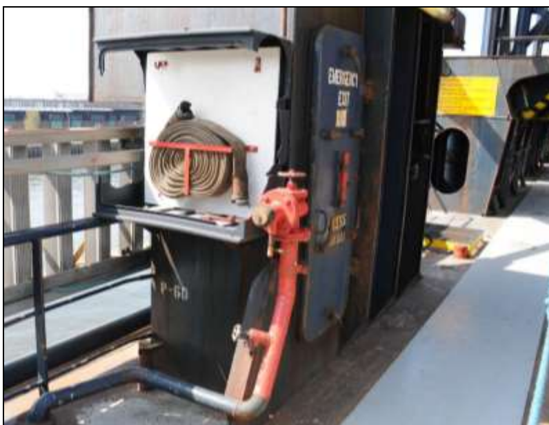
Abbildung 3: Notausstieg für Ro-Ro-Decks 3, 2 und 1 auf dem Hauptdeck
