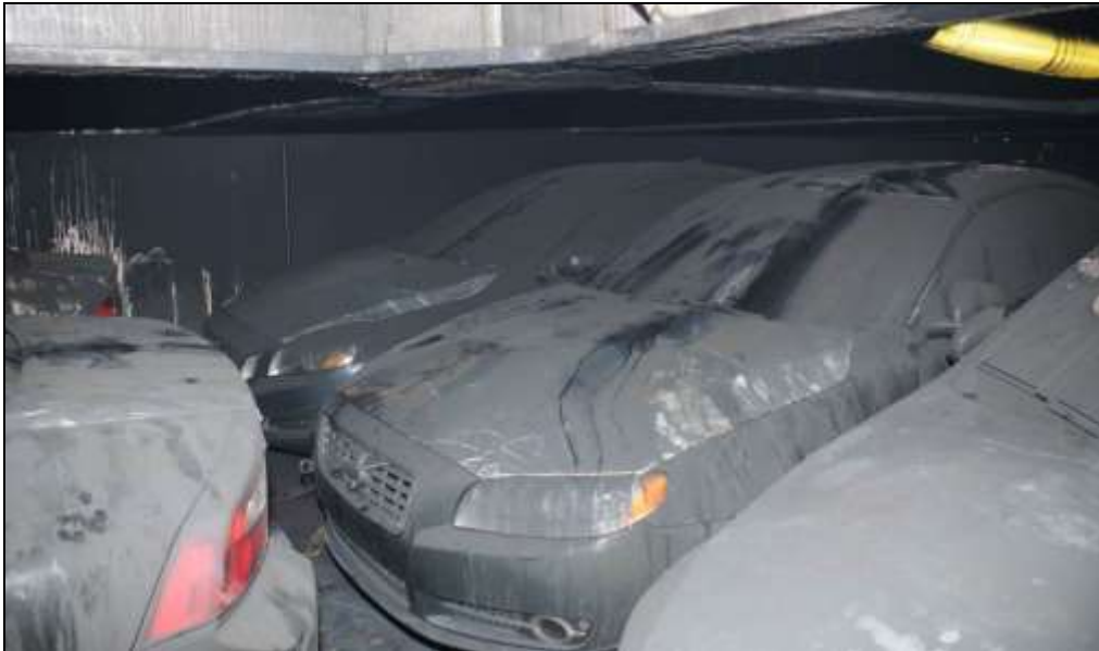
Abbildung 9: Stark verrußte PKW
