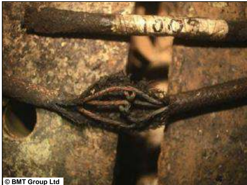
Abbildung 70: Beispiel für Metallleiter-Schleifen innerhalb der Isolierung 43
