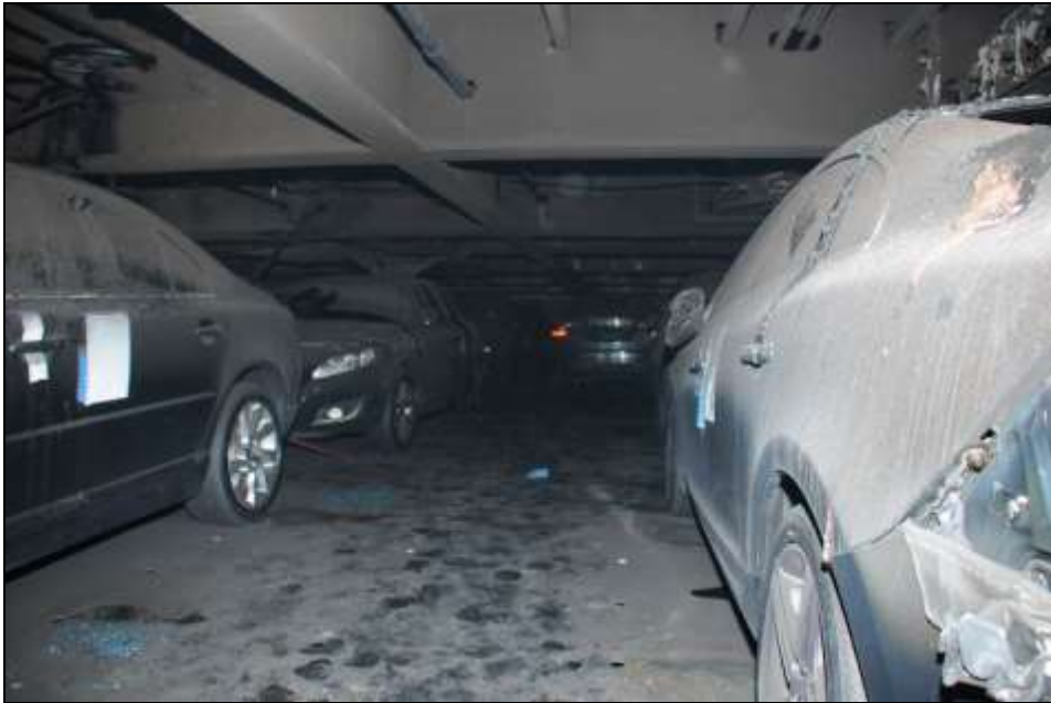
Abbildung 49: Brandausbreitung durch Konvektion, nicht positionsabhängig vom Entstehungsort
