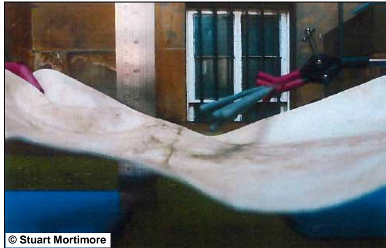
Abbildung 94: Versuchsaufbau zur Entzündbarkeit einer Schutzplane 67
