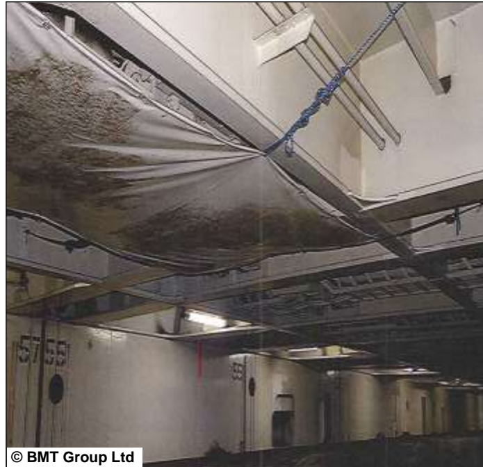
Abbildung 75: Beispiel für eine unter der Laderaumdecke gespannte Schutzplane
