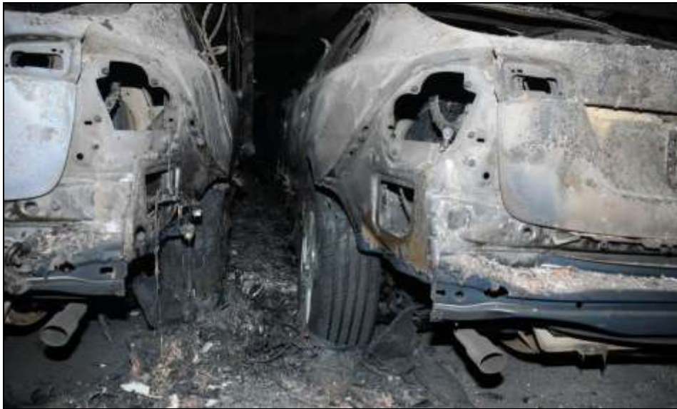
Abbildung 48: Brandausbreitung von oben über Wärmestrahlung
