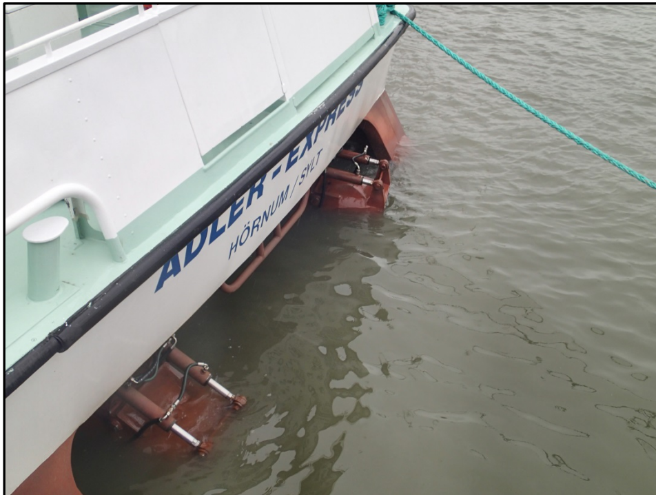
Abbildung 4: MJP- Waterjet Antrieb
