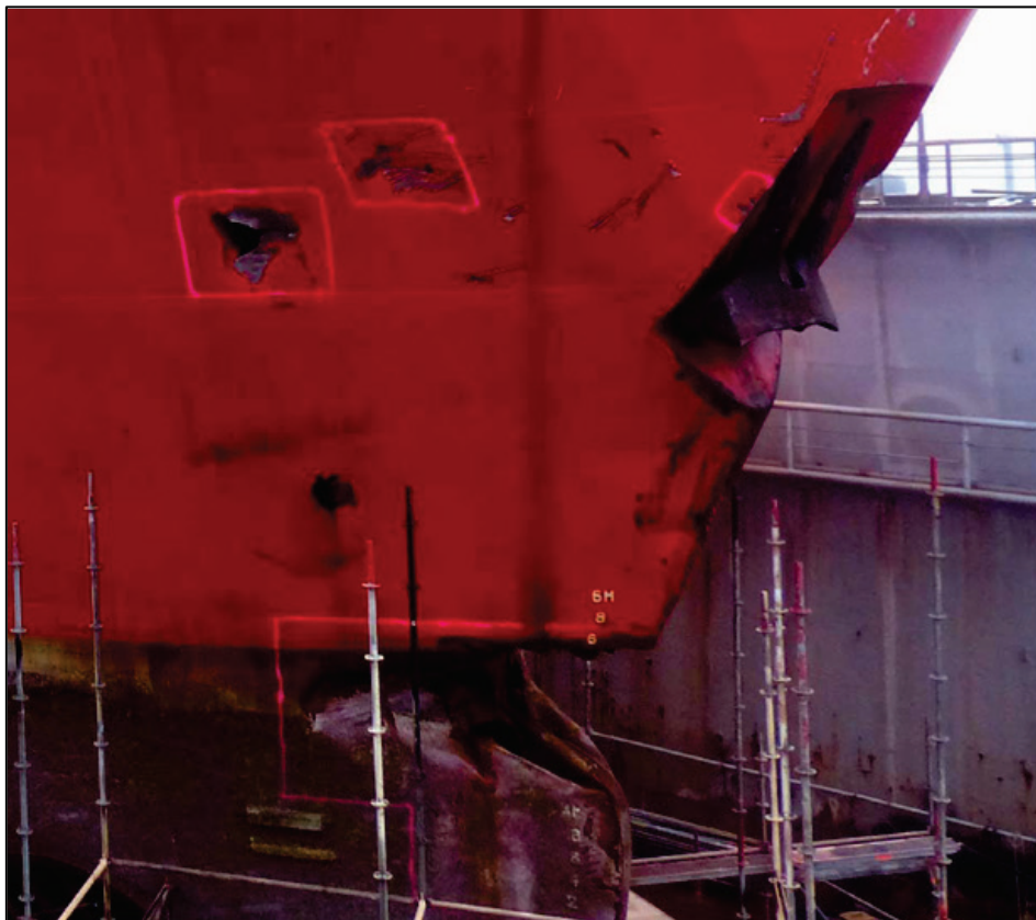
Abbildung 19: Schäden am Bug
